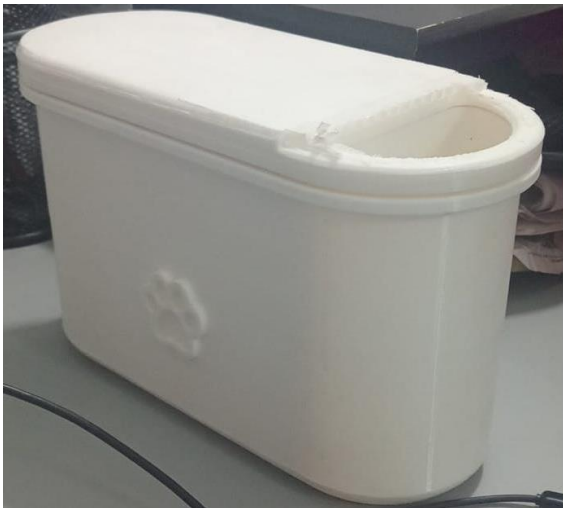
21 imagen. Cuerpo, pieza en PLA recién impresa.
