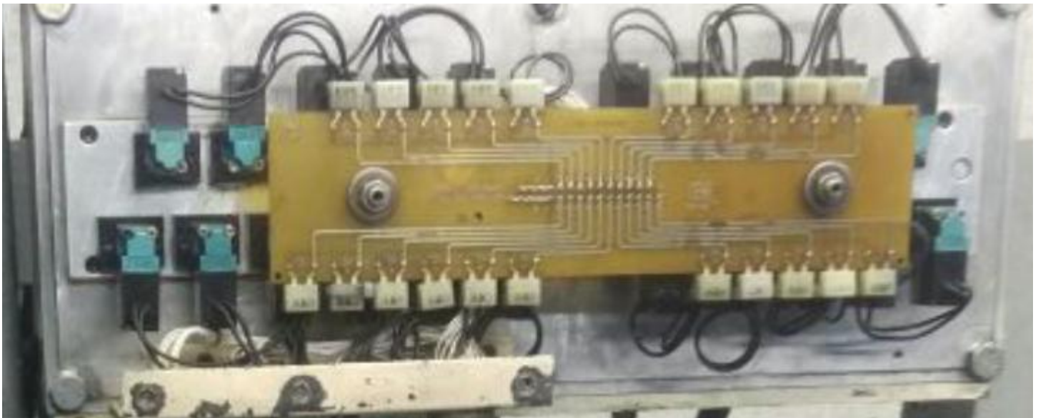
IMAGEN 3: bloque de electroválvulas
