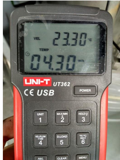
Foto del dato tomado con el anemómetro en el primer punto de la matriz (GONZALEZ YEPES, Figura, 2017)
