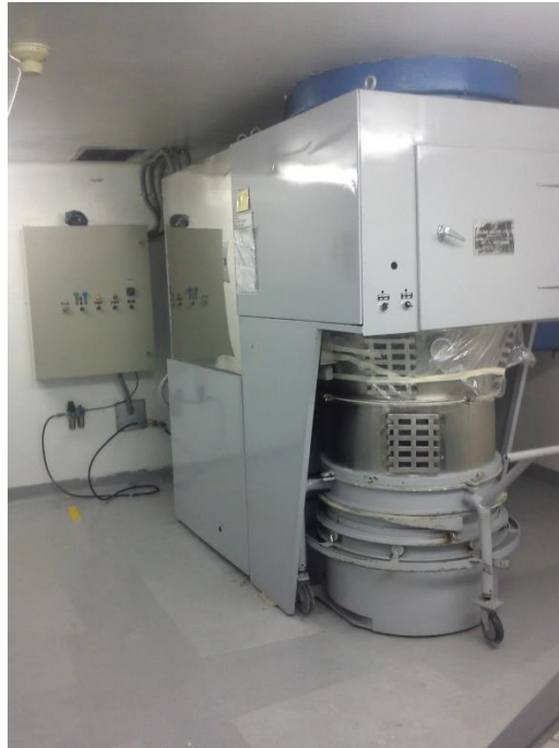
Foto del lecho fluido utilizado para los ensayos (GONZALEZ YEPES, Figura, 2017)
