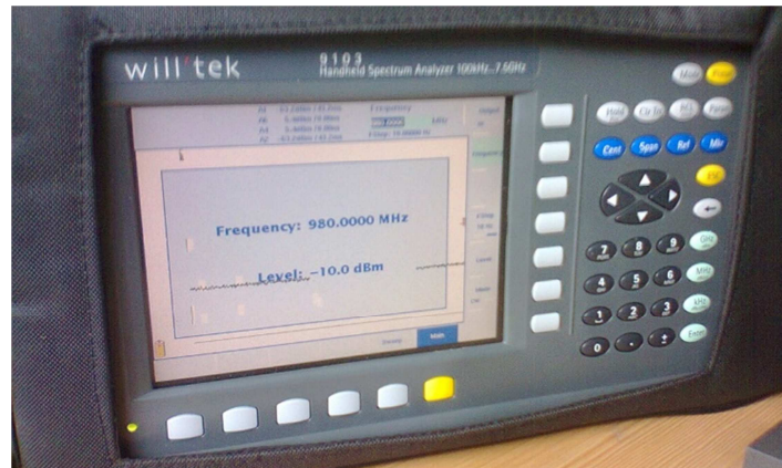
Figura 9. Analizador Will' Tek 9103 utilizado como generador de RF.
