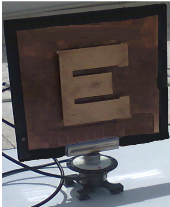
Figura 5 Diseño construido de antena Microstrip en forma de “E”
