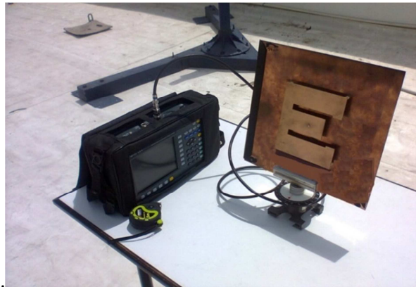
Figura 14. Montaje de la antena con el generador RF para identificar el patrón de radiación.
