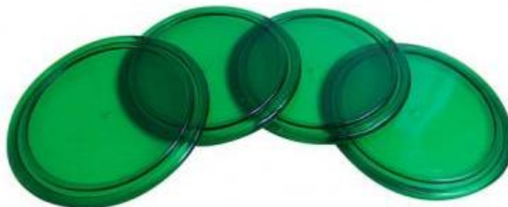
Figura 16. Piezas inyectadas de 1.3 mm de espesor (molde portavasos).
