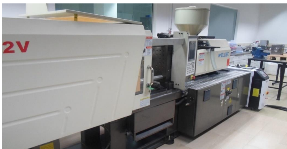
Figura 18. Inyectora empleada para realizar las mediciones de energía.
