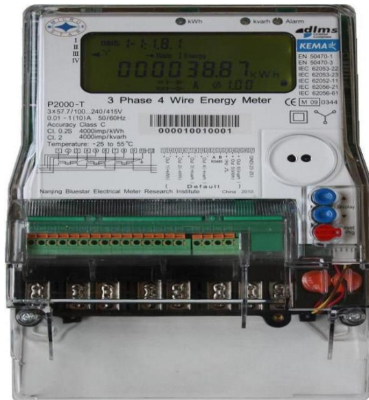
Figura 6. Medidor eléctrico microstar (7)
