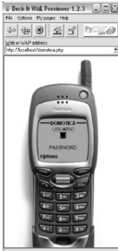
Ilustración 17. Interfaz gráfica del simulador WAP con la página diseñada en ejecución
