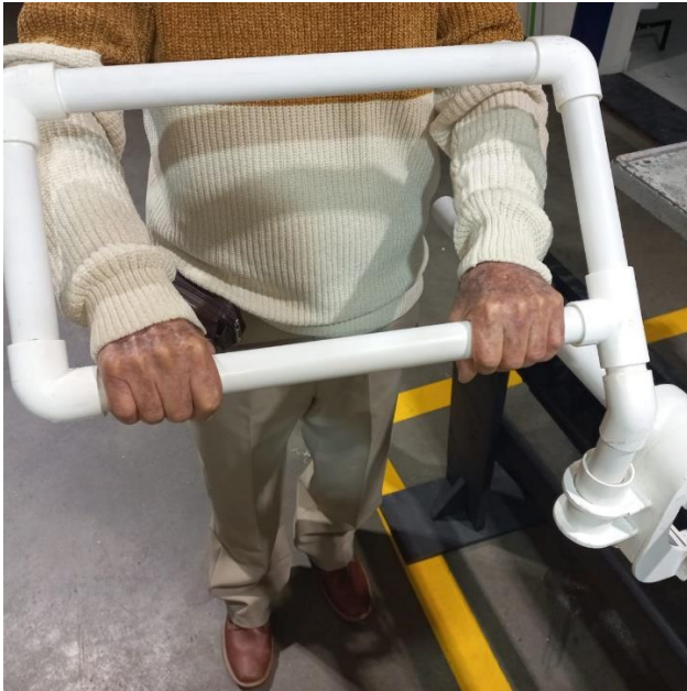
Figure 55 Validación del prototipo- mango ergonómico, Cristian Marín, 2024
