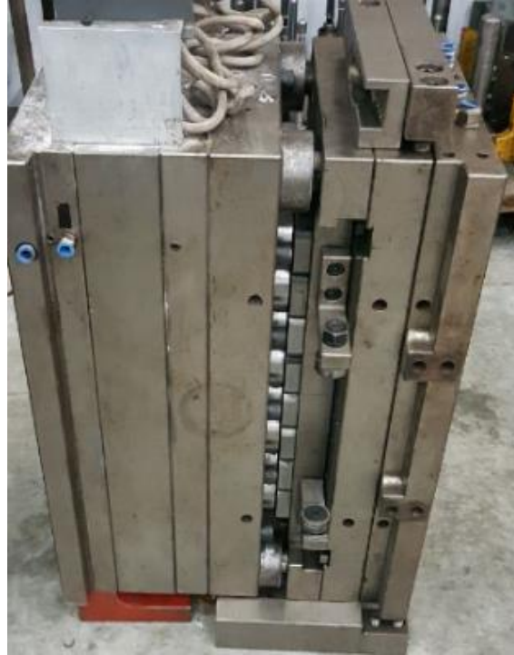
Figura 6. Molde típico de inyección de colada caliente
