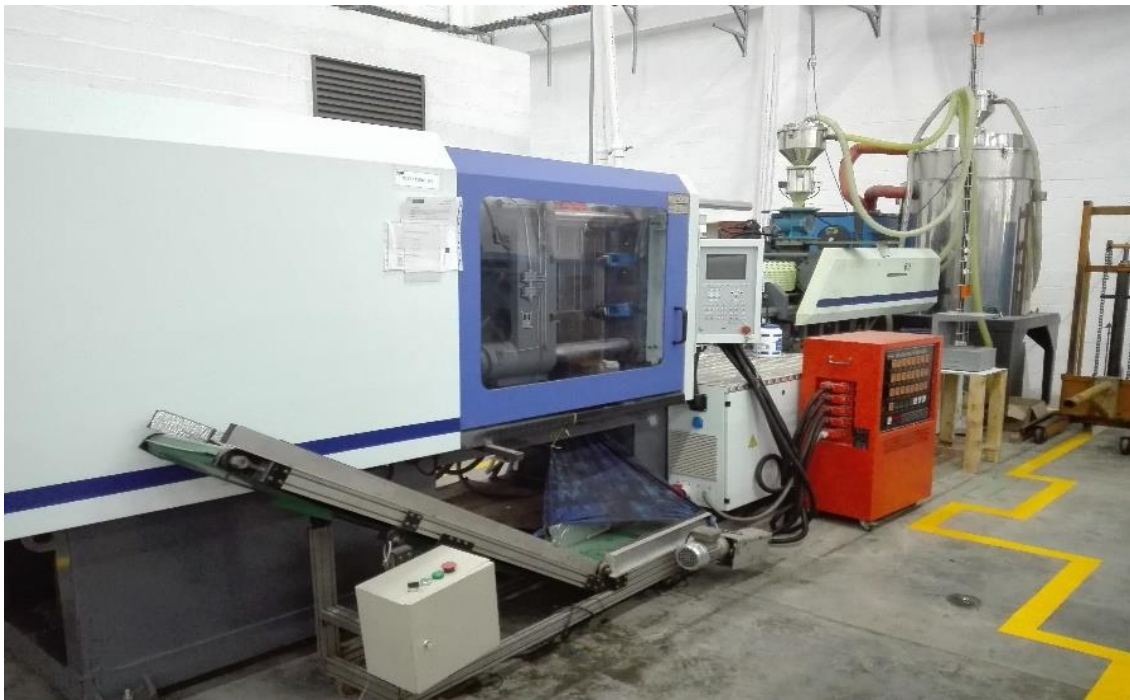
Figura 96. Máquina de inyección para preformas de 24 g.
