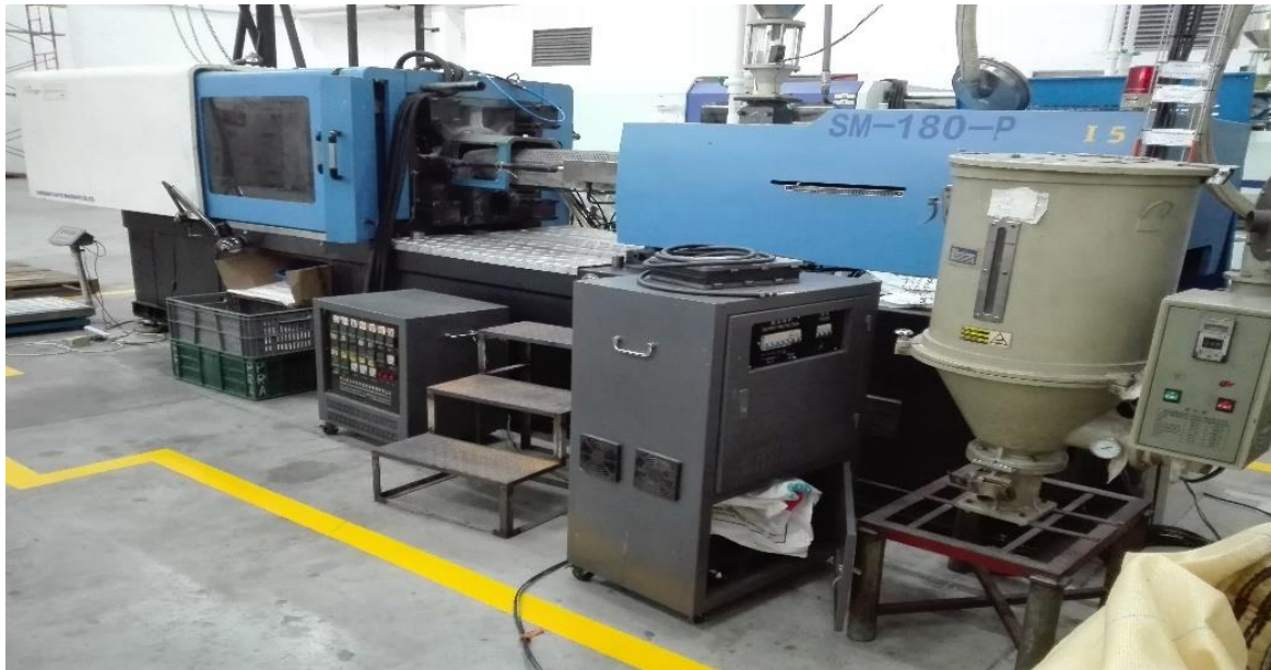
Figura 10. Máquina de inyección para preformas de 8,3 g.
