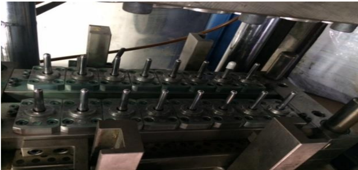
Figura 41. Sistema de machos y cavidades para el molde de 8,3 g.
