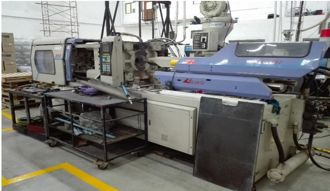
Figura 74. Máquina de inyección para preformas de 5,4 g.
