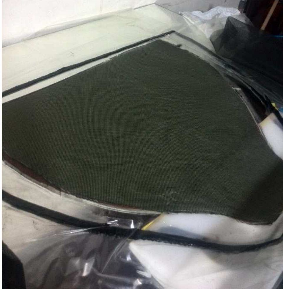
Figura 58. Desmolde. Fuente: creación propia.
