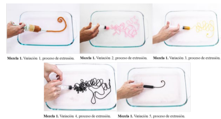
Figura 3. Proceso de extrusión de la mezcla 1 y sus variaciones en la mezcla 2. Autoría: Diana Urdinola y Carlos Castaño. Fotos de Felipe Ramírez.
