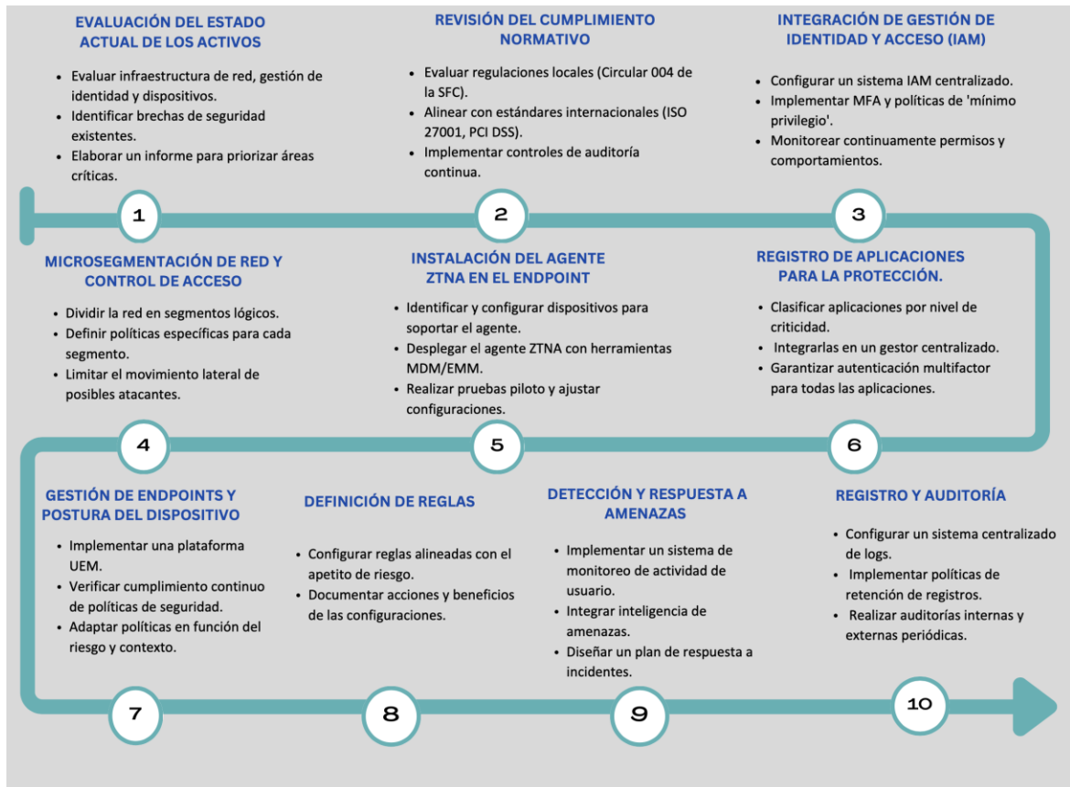
Figura 24. Diagrama de la Metodología Propuesta para el Control de Acceso a la Red Basado en Zero Trust
