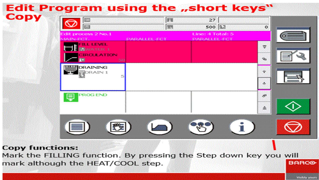
Figura 45. Imagen HMI Función de llenado insertada en la receta. Fuente: propia.
