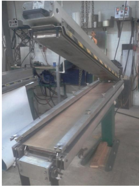
Figura 6. Vulcanizadora bandas de transporte.
