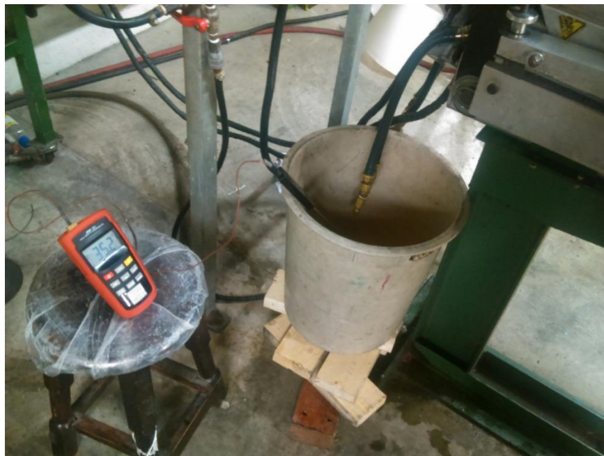
Figura 106. Medición de Temperatura salida agua vulcanizadora.
