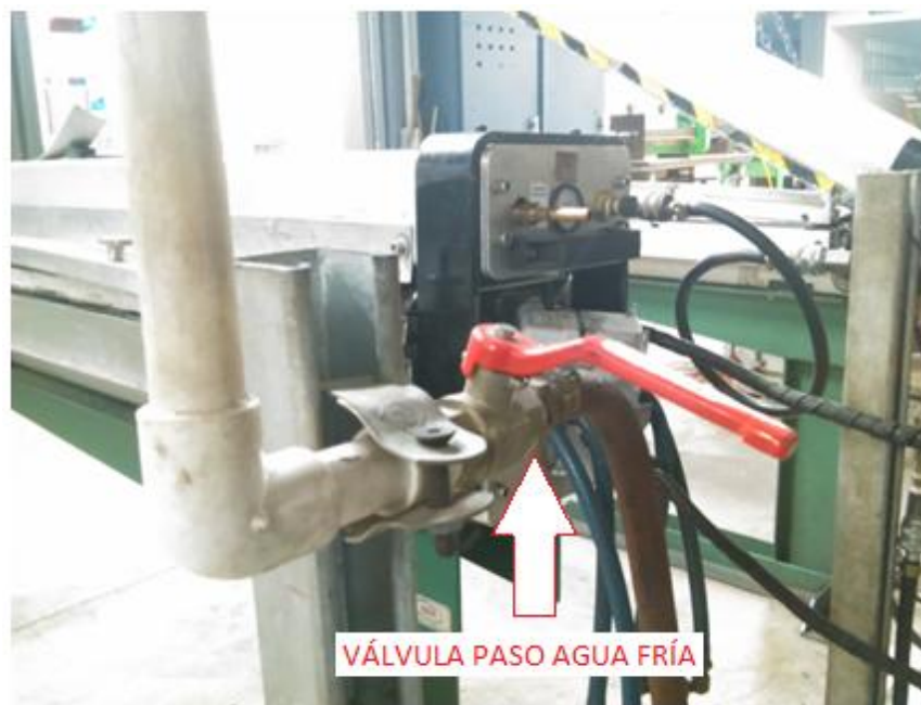
Figura 100. Válvula para el paso del agua en el proceso de vulcanizado
