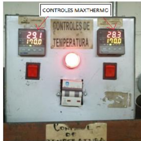
Figura 99. Caja de control para vulcanizadoras.
