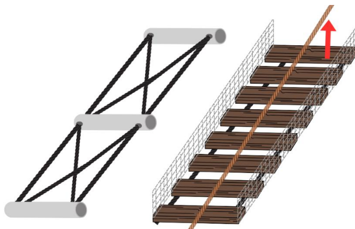
Figura 56. Ejemplo de recubrimiento de pasarela con malla – Fuente propia
