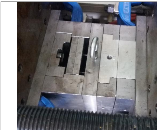
Figura 10. Molde montado en inyectora con salida de la fibra.
