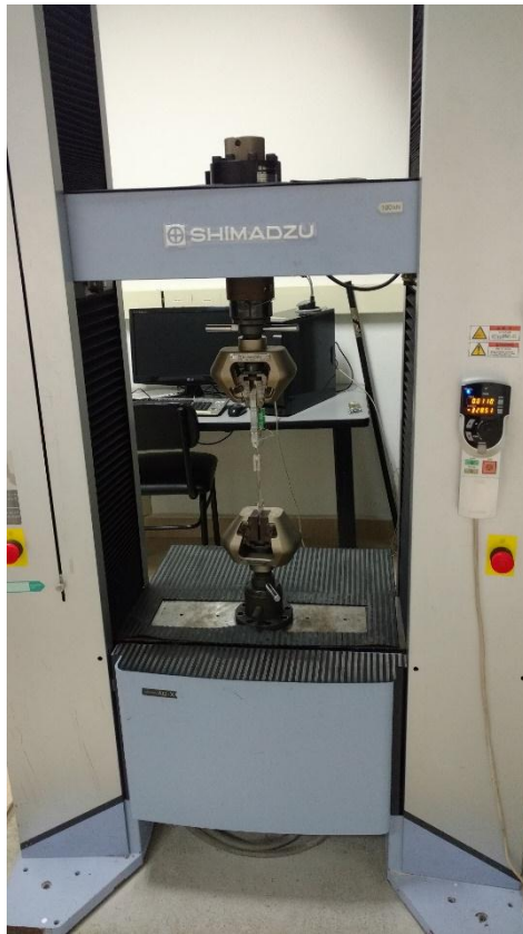
Figura 23. Fibras individuales de refuerzo en máquina universal de ensayos mecánicos.
