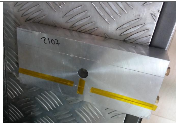
Figura 11. Ranura longitudinal en superficie de molde.
