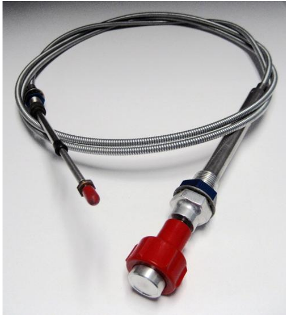
Figura 4 Guaya para control de aceleración usada en aviación (tomada de Aircraft Spruce & Specialty Co.).
