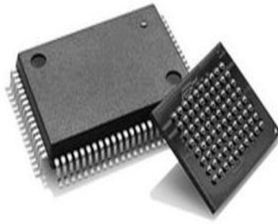
Imagen 3: Memoria flash NOR Imagen tomada de (DirectIndustry, 2015)
