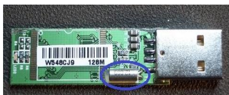
Imagen 33: Cristal de cuarzo del pendrive imagen tomada de (solo electrónico, 2014)
