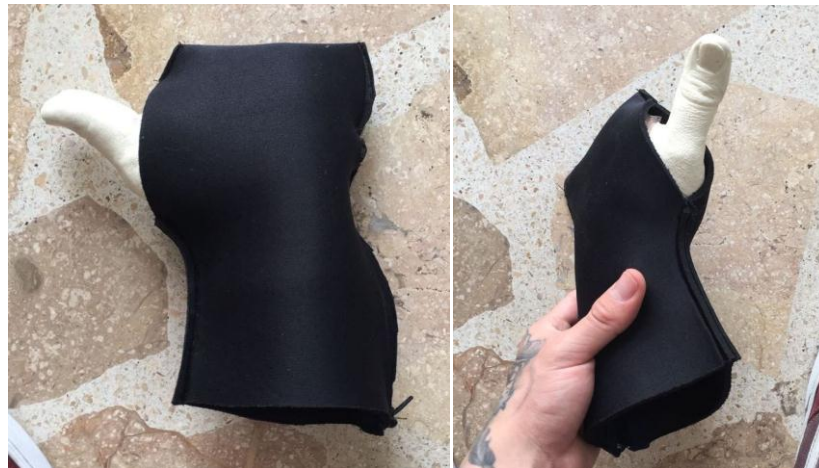
Figura 34 Forrado molde con Neopreno
