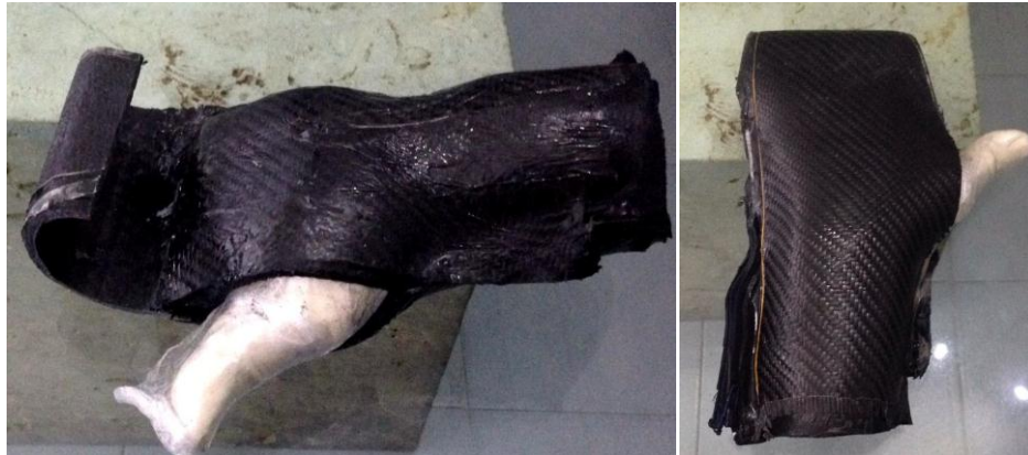
Figura 17 Proceso de corte y pulido fibra de carbono
