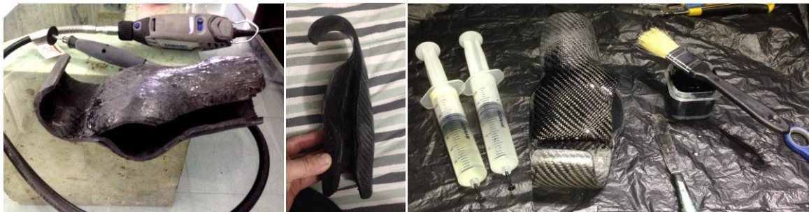
Figura 36 Proceso de corte y pulido
