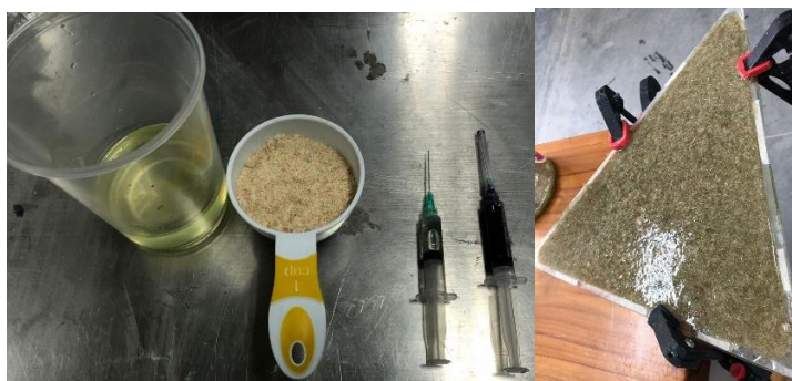
Ilustración 22, Prueba 8, 125g de ecoresina, 25g de fibra de fique, 1,5g de peroxicol 80, 0,7g de octoato de cobalto al 6%.
