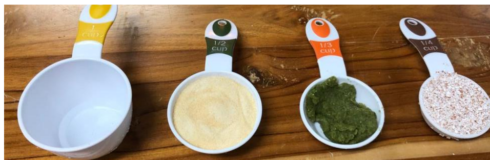
Ilustración 18, Prueba 4, 250ml de agua, 30g de gelatina sin sabor, 75ml de glicerina, 1/3 cup de papel reciclado, fibra de piña, cascara de piña, cascara de huevo.
