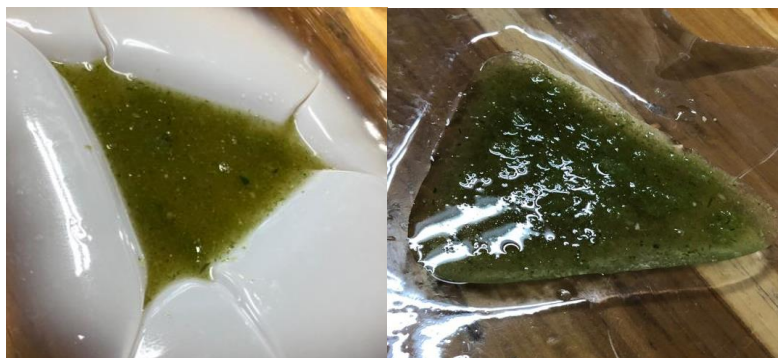
Ilustración 18, Prueba 4, 250ml de agua, 30g de gelatina sin sabor, 75ml de glicerina, 1/3 cup de papel reciclado, fibra de piña, cascara de piña, cascara de huevo.
