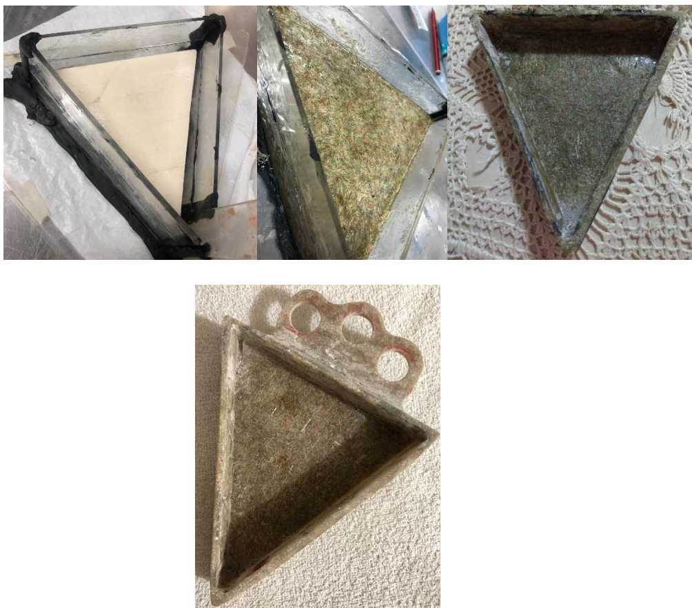
Ilustración 23, Prueba 9, 225g de ecoresina, 250g de fibra de fique, 3,3g de peroxicol 80, 1,06g de octoato de cobalto al 6%.
