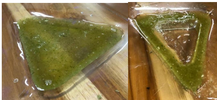
Ilustración 17, Prueba 3, 175ml de agua, 30g de gelatina sin sabor, 20ml de glicerina, 1/3 cup de papel reciclado, fibra de piña, cascara de piña, cascara de huevo.
