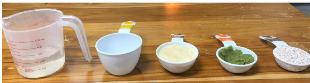
Ilustración 16, Prueba 2, 60ml de agua, 2 cucharadas soperas de gelatina sin sabor, 2 cucharada soperas de papel reciclado, fibra de piña, cascara de piña, cascara de huevo
