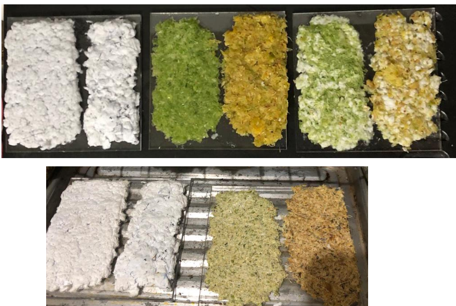
Ilustración 16, Prueba 2, 60ml de agua, 2 cucharadas soperas de gelatina sin sabor, 2 cucharada soperas de papel reciclado, fibra de piña, cascara de piña, cascara de huevo
