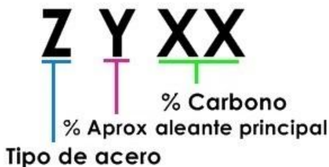
Imagen 21: nomenclatura de los aceros con la norma AISI-SAE
