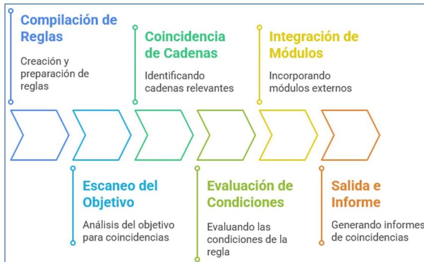
Fig. 16: Proceso de operación de regla YARA
