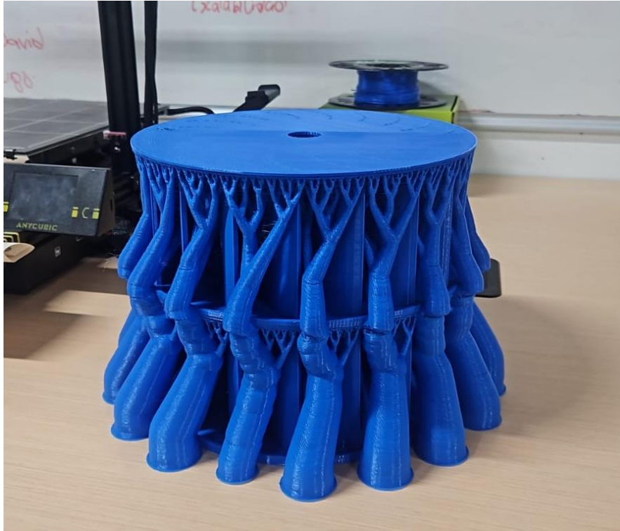
Fotografía 3-3: Turbina impresa con soportes de construcción
