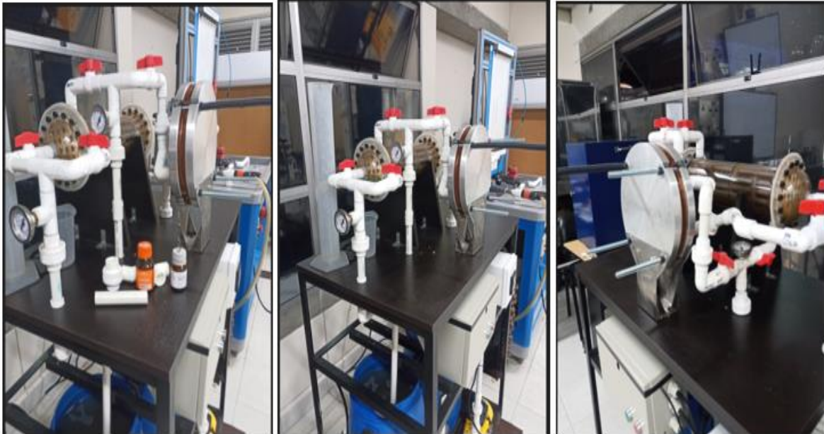
Figura 23. Montaje del intercambiador en el banco del laboratorio Fuente: propia
