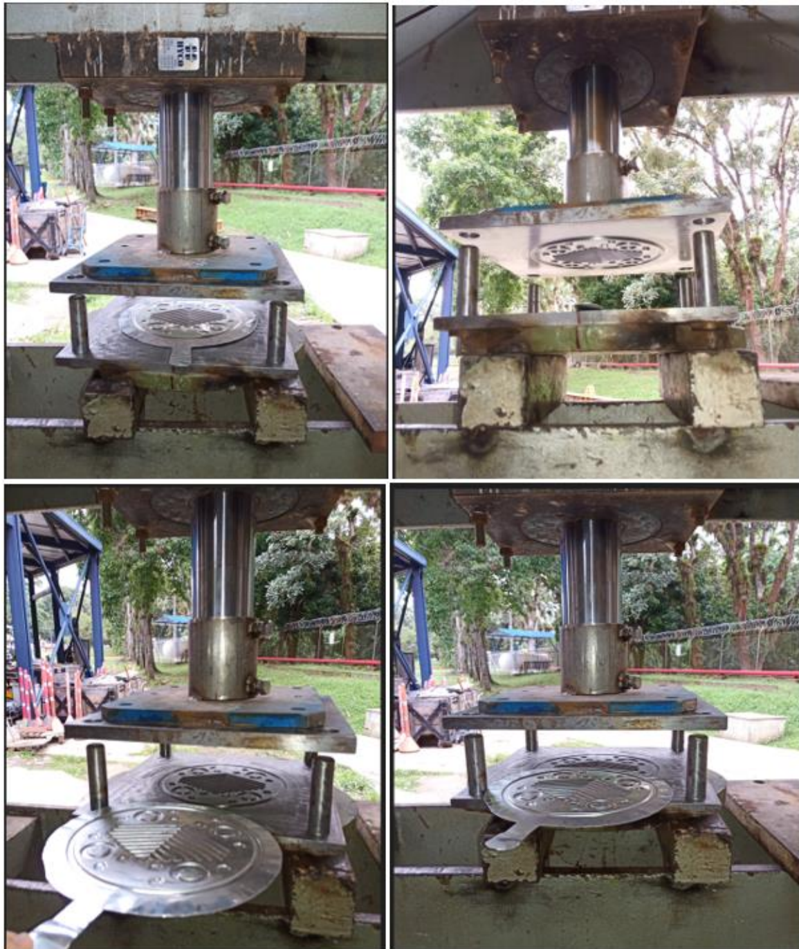
Figura 20. Posicionado de lámina de placa para troquelado (Superior izquierda); apertura del troquel luego de presar la placa (Superior derecha), extracción de placas corrugadas terminadas del troquel (Inferior izquierda y derecha).
