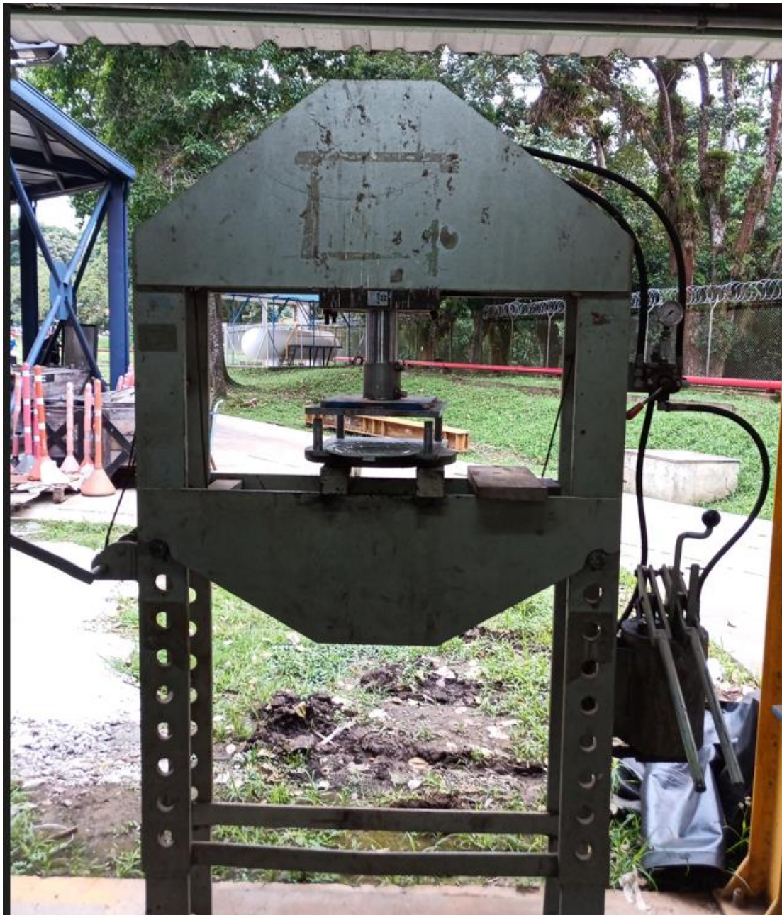
Figura 19. Prensa hidráulica de 50 toneladas y montaje de troquel. Fuente: propia
