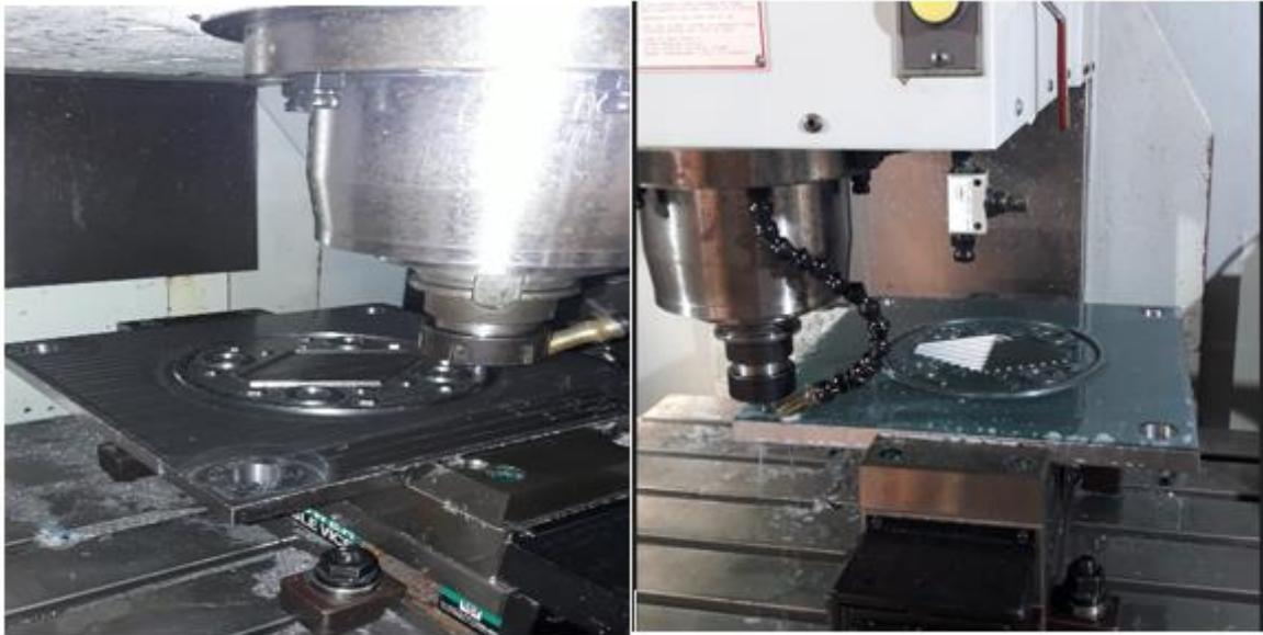
Figura 18. Cara positiva y negativa del troquel Fuente: propia
