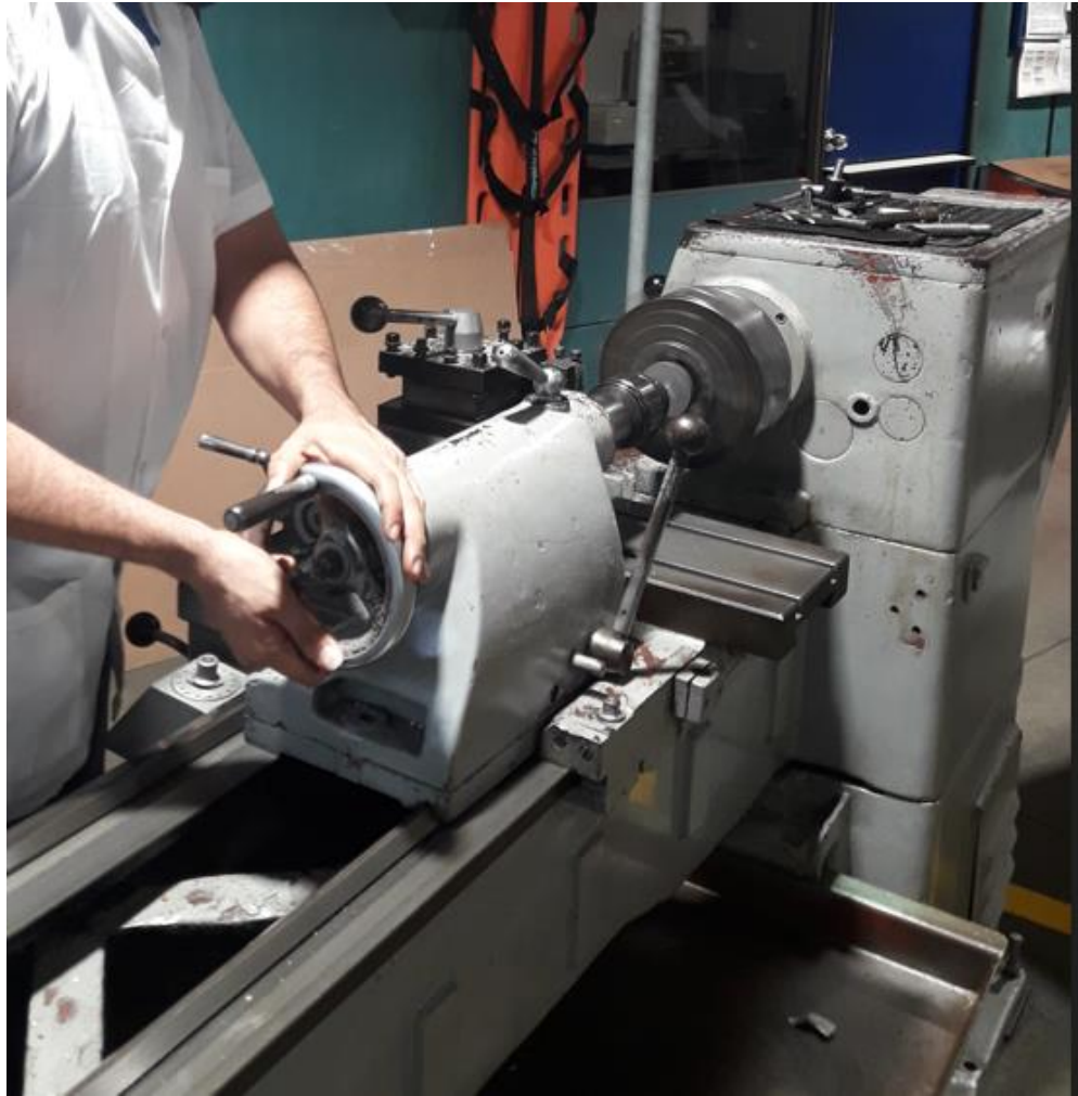
Figura 15. Maquinado de troqueles de perforación de placas corrugadas. Fuente: propia
