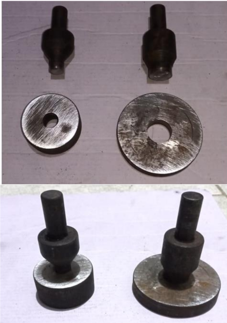
Figura 16. Troquel de perforación de 10mm (Superior e inferior izquierda) y de perforación de 21mm (Superior e inferior derecha). Fuente: propia
