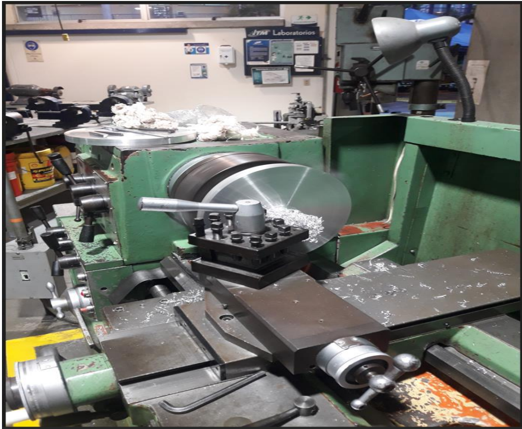
Figura 14. Maquinado de cabezales fijo y móvil para el intercambiador de placas. Fuente: propia
