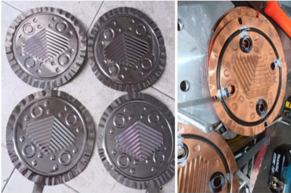
Figura 21. Placas corrugadas del intercambiador troqueladas y perforadas Fuente: propia
