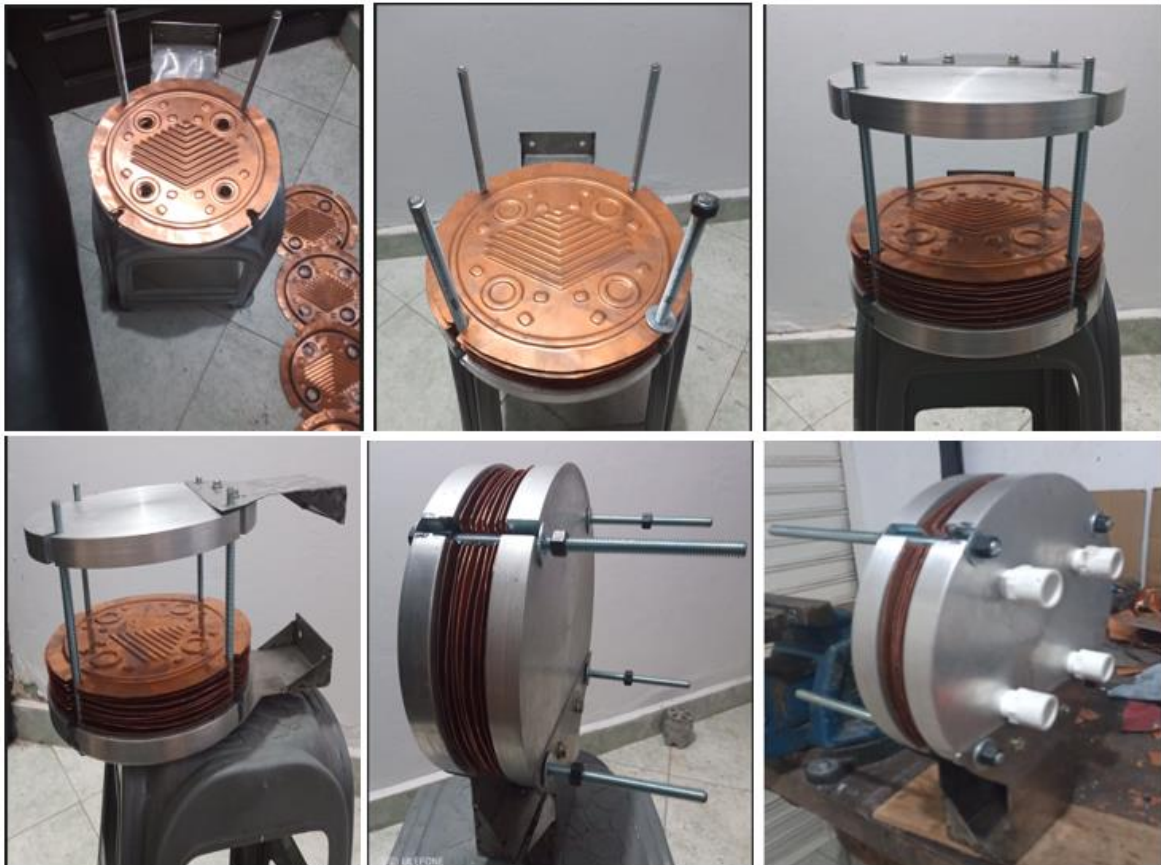
Figura 22. Ensamble del intercambiador: Instalación de cabezal fijo, primera placa corrugada y barras guía (Superior izquierda); posicionamiento total de placas corrugadas, juntas y barras guía (Superior central); instalación cabezal móvil (Superior derecha); Instalación soportes de cabezales fijo y móvil (Inferior izquierda); Ajuste y torqueo de placas corrugadas (Inferior central) e instalación de niples de PVC (Inferior derecha) Fuente: propia
