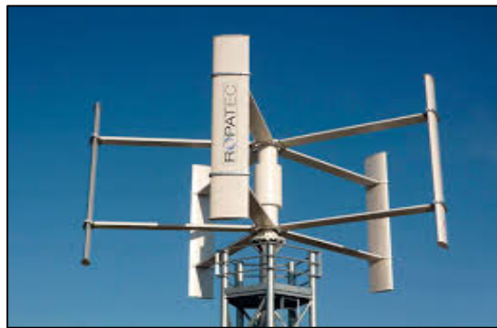
Figura 8. Modelo de aerogenerador Giromill. Fuente: (Barragan, 2015).
