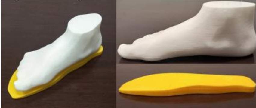
Figura 0.9 Prototipo de plantilla que reduce riesgos de lesión logrando una adecuada distribución de la presión plantar
