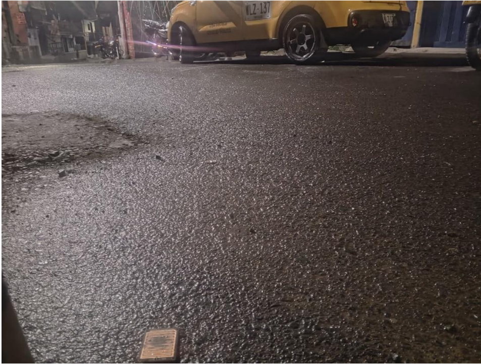
Figura 152. Sensor YL-83 ubicado en una segunda posición con el fin de comparar la estabilidad y respuesta de los datos obtenidos bajo diferentes condiciones de instalación.
