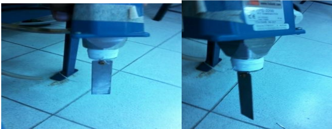
Figura 21. Sensor de flujo, aleta de 1".
