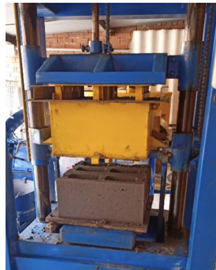
Figura 7. Bloques después de ser liberados por la máquina vibrocompactadora. Fuente: elaboración propia.
