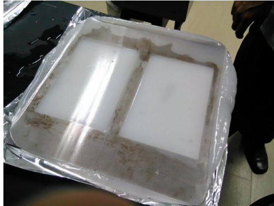
Figura 8: placas plásticas rectangulares hechas por moldeo por compresión.
