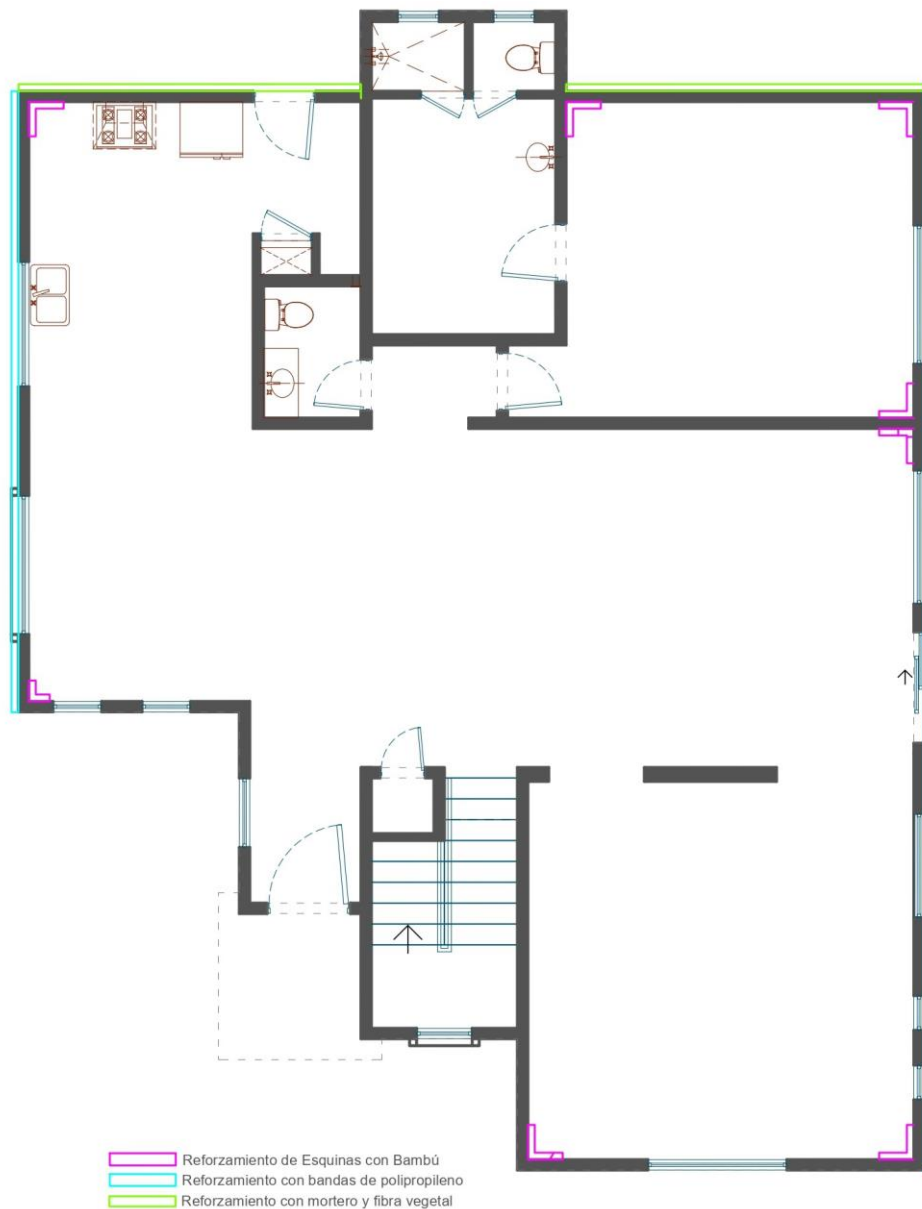
Figura 4-12. Localización de medidas de intervención no convencionales en esquinas y muros de una planta típica.
