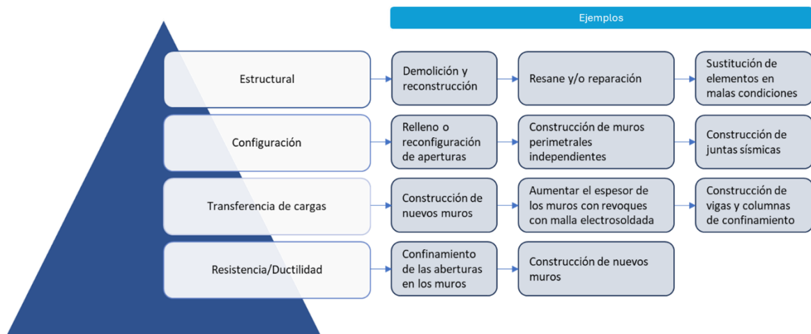
Figura 4-2. Priorización de condiciones a subsanar en una edificación.
