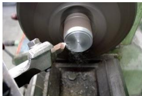
Figura 32. Fabricación de buje de unión Fuente: Propia.
