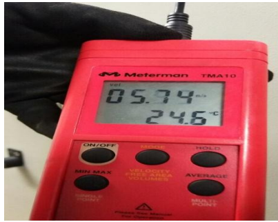
Figura 39. Velocidad y temperatura del aire. Fuente: Propia.
