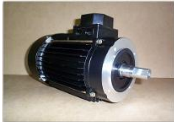
Figura 24. Motor eléctrico trifásico jaula de ardilla marca Siemens Fuente: Propia.
