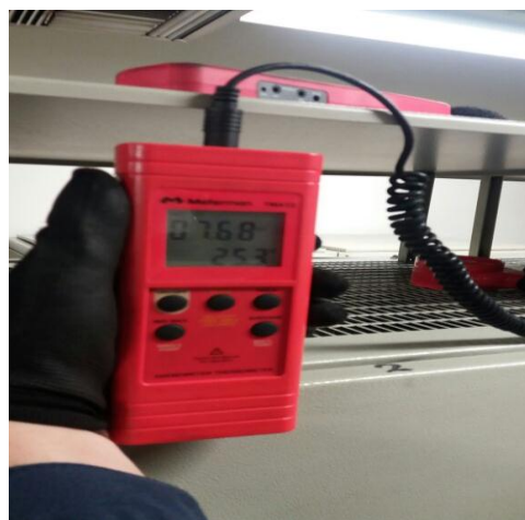
Figura 44. Velocidad y temperatura del aire extraído 2 Fuente: Propia.
