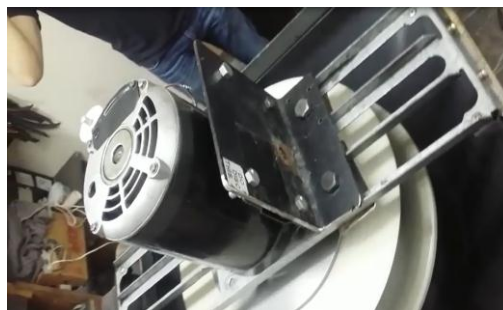
Figura 36. Platina a 900 para evitar vibración. Fuente: Propia.
