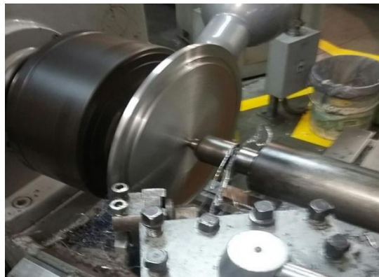
Figura 30. Fabricación de disco o plato de unión. Fuente: Propia.
