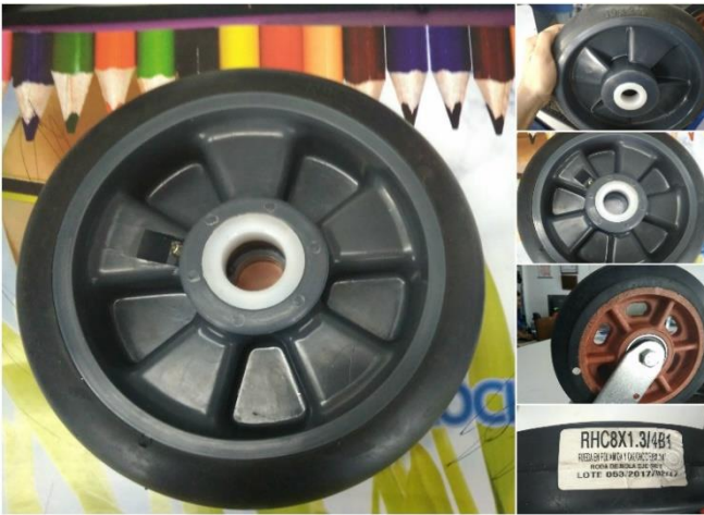
Figura 23. Selección ruedas para el dispositivo. Ver ficha técnica en anexo.
