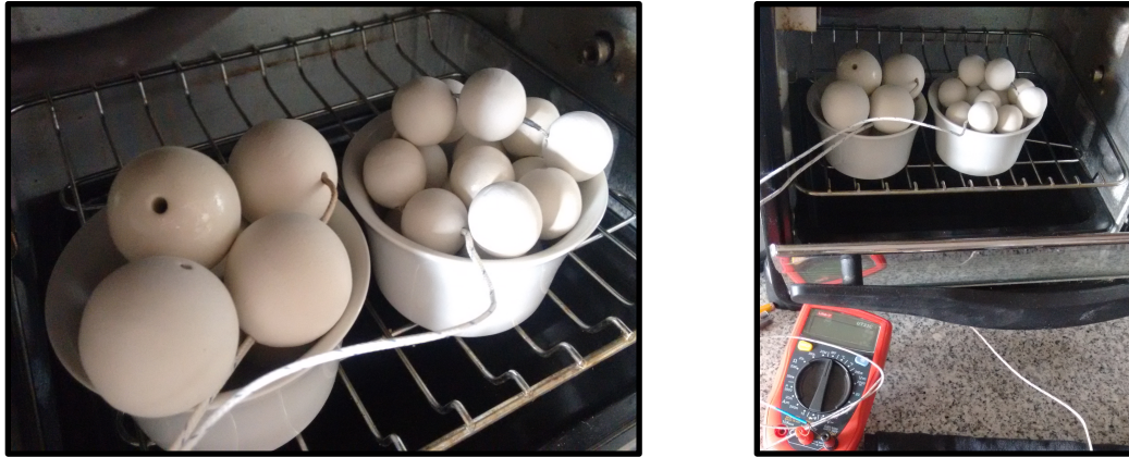
Figura 15. Medidor de temperatura embebido en un material cerámico esférico. Fuente: Autor
