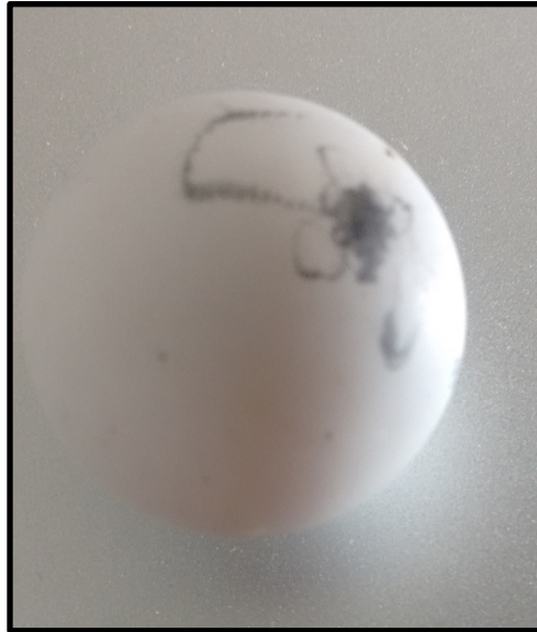
Figura 20. Esfera de alúmina de alta densidad, con ensayo de perforación. Fuente: Autor
