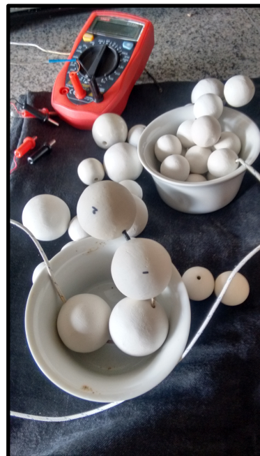
Figura 23. Collar de esferas con el termopar embebido. Fuente: Autor
