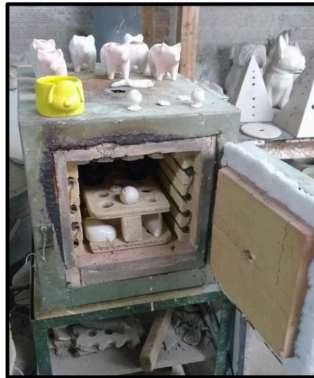
Figura 30. Horno para proceso de esmaltado a 1200 °C. Fuente: Autor
