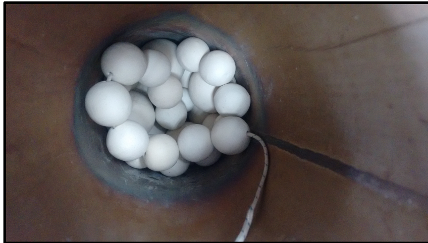
Figura 24. Collar y esferas empacadas en el recuperador de calor. Fuente: Autor.
