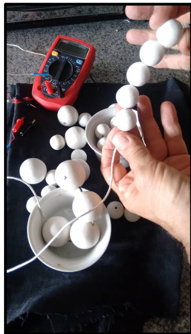
Figura 23. Collar de esferas con el termopar embebido. Fuente: Autor
