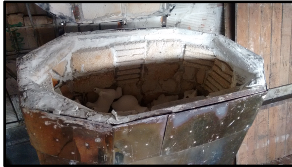
Figura 29. Horno para cocción a 900 °C. Fuente: Autor
