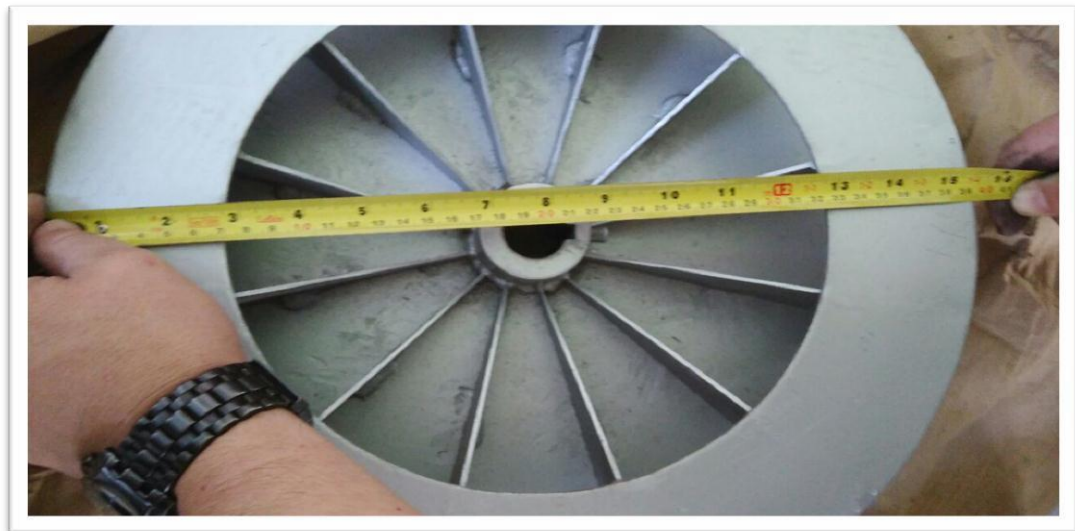
Figura 15. Diámetro ventilador. Fotografía tomada por los autores.
