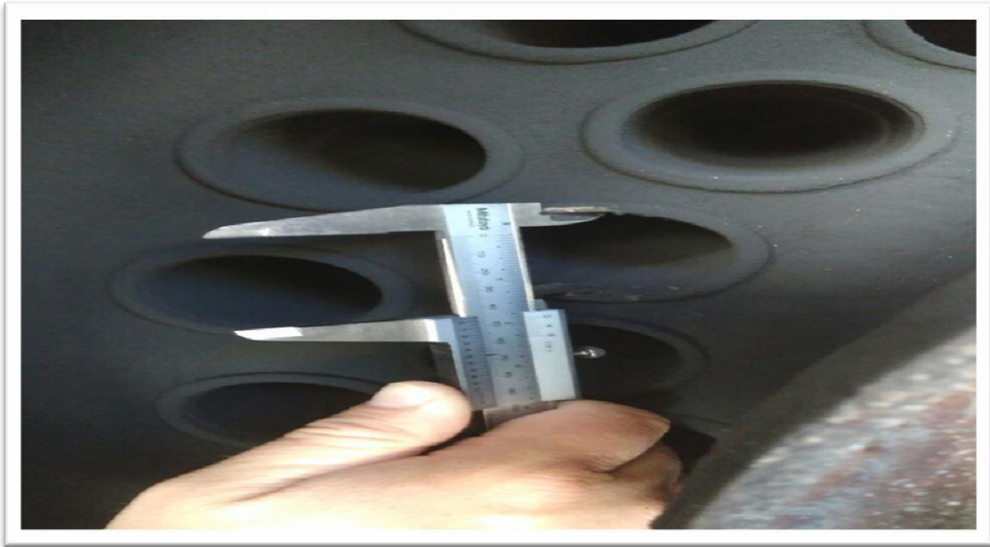
Figura 16. Diámetro tubería interna. Fotografía tomada por los autores.
