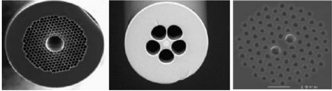
Imágenes de la sección transversal de fibras de cristal fotónico.
