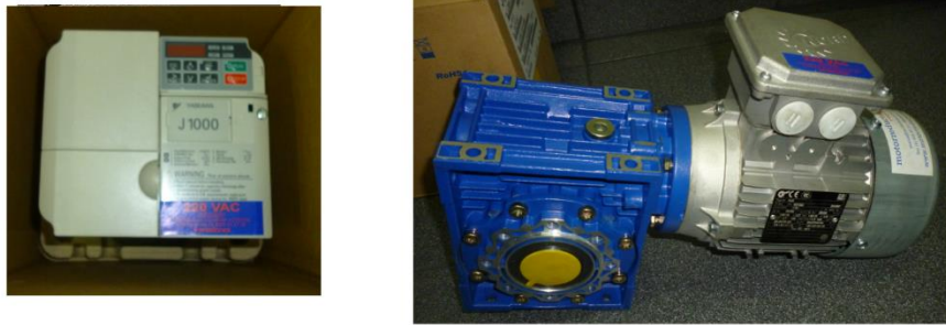
Figura 51. Fotografías motorreductor Nord y Variador de Velocidad Yaskawa (Fuente: Autor).
