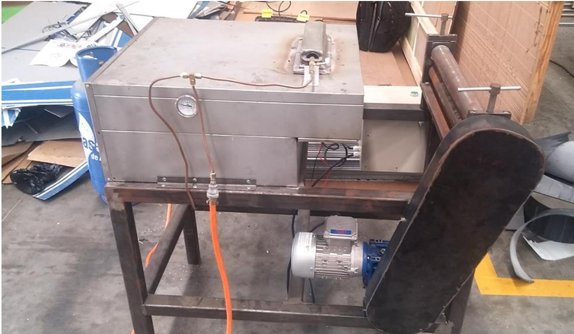
Figura 54. Fotografía Final del sistema Separador Alucobond (Fuente: Autor).
