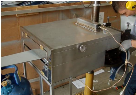
Figura 43. Fotografías de Proceso Manual separación lamina Alucobond. “Fuente: Autor”.
