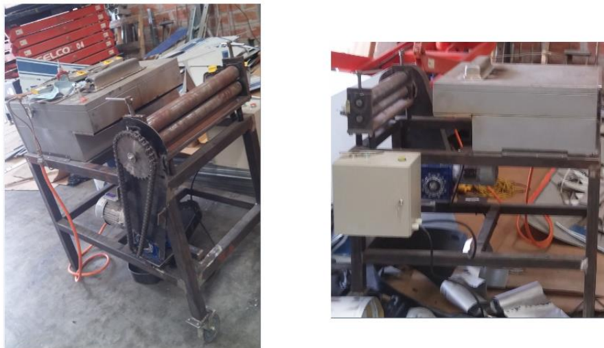
Figura 53. Fotografías ensamble del sistema Separador Alucobond (Fuente: Autor).
