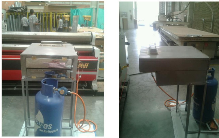
Figura 28. Fotografías de horno separador Alucobond. “Fuente: Autor”.
