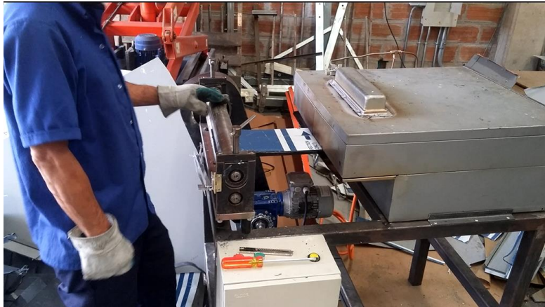
Figura 56. Fotografía Saliendo lamina de Alucobond del horno entrando en Rodillos. (Fuente: Autor).
