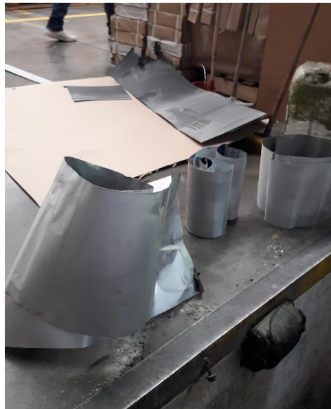
Figura 68. Fotografía Separación de Lámina Alucobond en placa aluminio por dos por una de polietileno. “Fuente Autor”.
