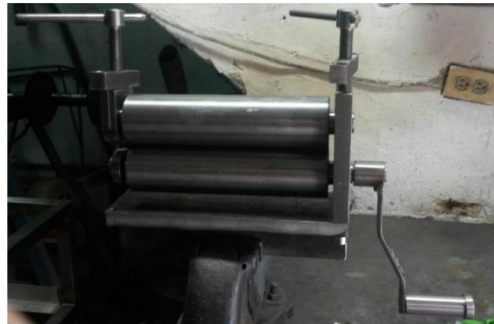
Figura 40. Fotografías ensamble sistema separador Mecánico Alucobond. “Fuente: Autor”.
