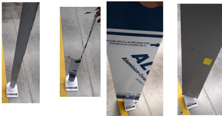
Figura 67. Fotografía Medición de peso a Láminas a separar. “Fuente Autor”.
