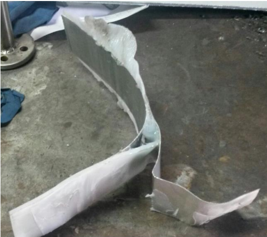
Figura 30. Fotografías de fusión polietileno en Placa Alucobond. “Fuente: Autor”.
