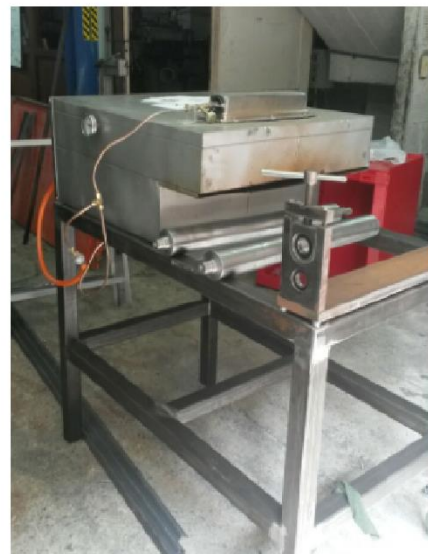
Figura 49. Fotografías estructura Final del sistema Separador Alucobond (Fuente: Autor).
