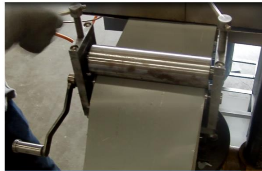
Figura 43. Fotografías de Proceso Manual separación lamina Alucobond. “Fuente: Autor”.
