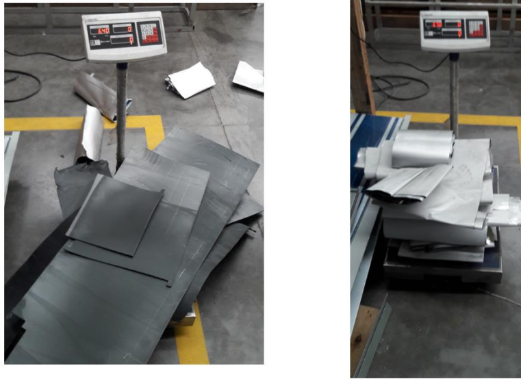
Figura 69. Fotografía de Medición peso de Separación de Lámina Alucobond en placa aluminio por dos por una de polietileno. “Fuente Autor”.
