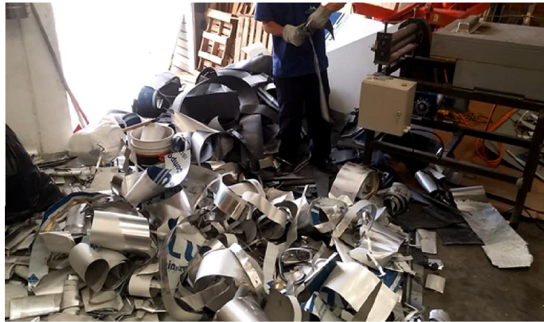
Figura 59. Fotografías Separación de Material Alucobond (Fuente: Autor).
