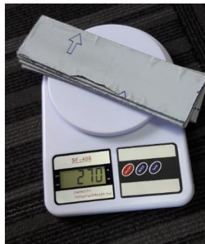
Figura 63. Fotografía Peso 4 probetas Material Alucobond 6 x 21.6 centímetros. “Fuente Autor”.
