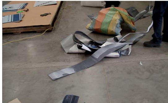
Figura 45. Fotografías de Proceso Manual separación lamina Alucobond. “Fuente: Autor”.
