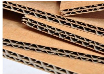
Ilustración 59. Doble Flauta: Ideales Para el Proyecto. Tomado Kartox/cuadernos
