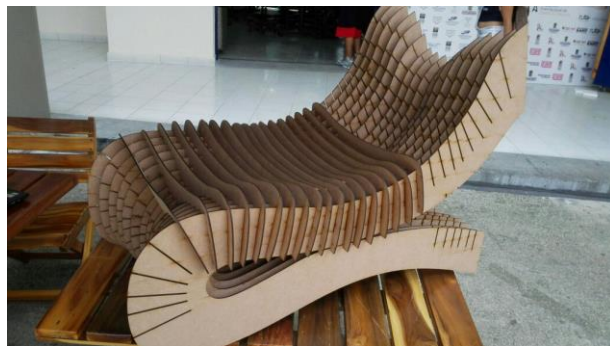
Ilustración 78. Prototipo en Proceso (MDF). Realización propia
