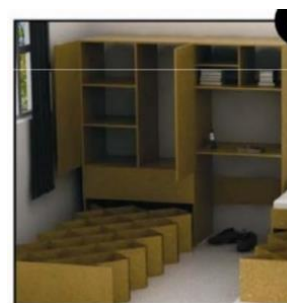
Ilustración 46. Render prototipo. Tomado de diseño y desarrollo de una línea de muebles hechos a partir de cartón corrugado para vivienda de interés social
