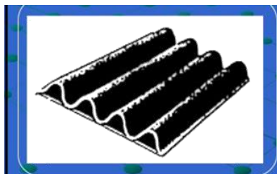
Ilustración 29. Una Sola flauta Tomado de Diseño y desarrollo de una línea de muebles hechos a partir de cartón corrugado para vivienda de interés social
