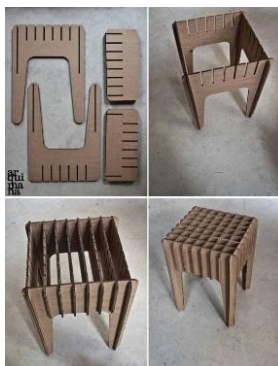
Ilustración 9. Proceso de Armado Estructura Costillada. Tomada de pinterest
