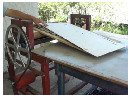
Ilustración 70. Corte Troquelado. Tomado de gráficos Nogueira
