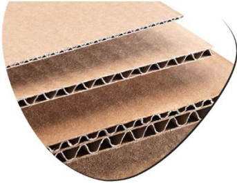
Ilustración 60. Composición Cartón Corrugado. Tomado de kartox/cuadernos
