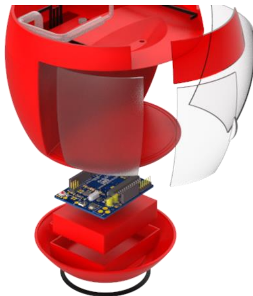
Figura 30: Ubicación Arduino en producto – Fuente: Elaboración Propia
