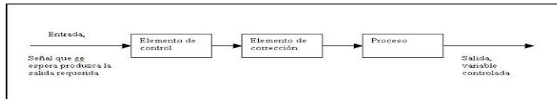
Ilustración 5: Control lazo cerrado, Fuente: (Salveti, 2012).
