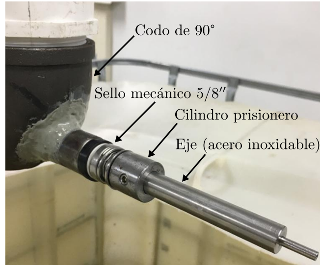
Figura 4-51. Implementación de un sello mecánico para sellar posibles fugas de agua.
