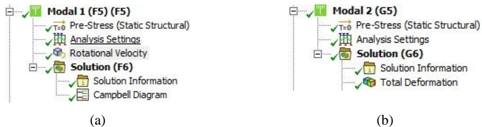
Figura 3-39. Árbol de configuración para (a) el primer módulo y (b) segundo módulo correspondientes al análisis modal.
