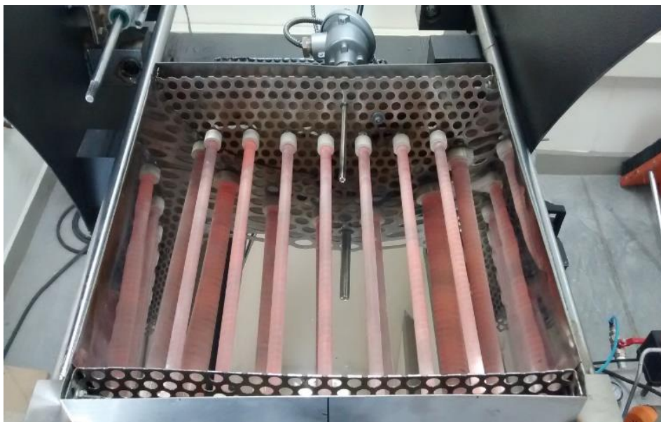
Figura 22. Aspecto de la campana de la termoformadora del ITM en operación (Fuente: autores)
