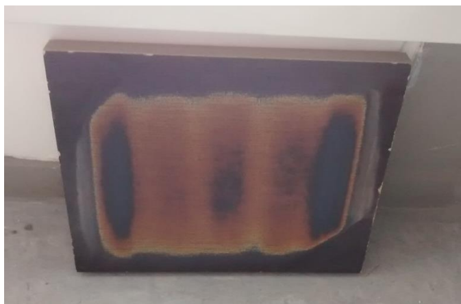
Figura 1. Quemado no uniforme de tabla de madera al ser calentada por la termoformadora del ITM. (Fuente: autores)
