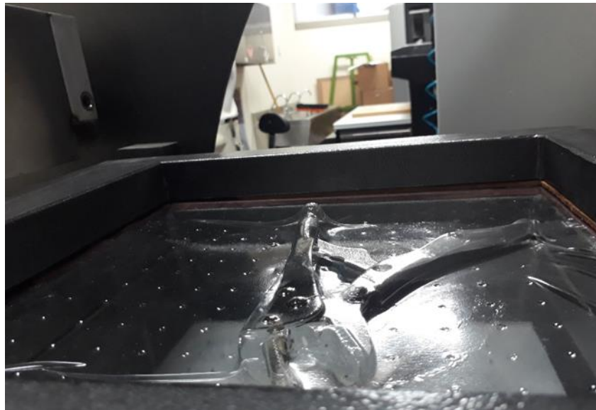
Figura 25. Termoformado por adaptación tras ensayos hechos en la maquina (Fuente: autores)
