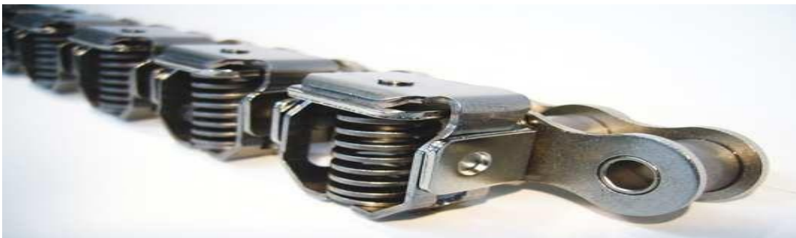
Figura 6. Fotografía de una cadena de arrastre de film. (GPS Reisacher, 2018)
