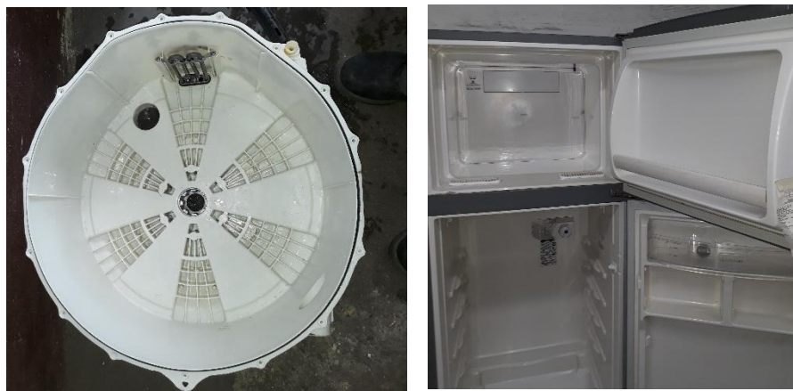
Figura 13. Tina de lavadora y molduras internas de neveras termoformadas en industria Haceb. (Fuente: autores)
