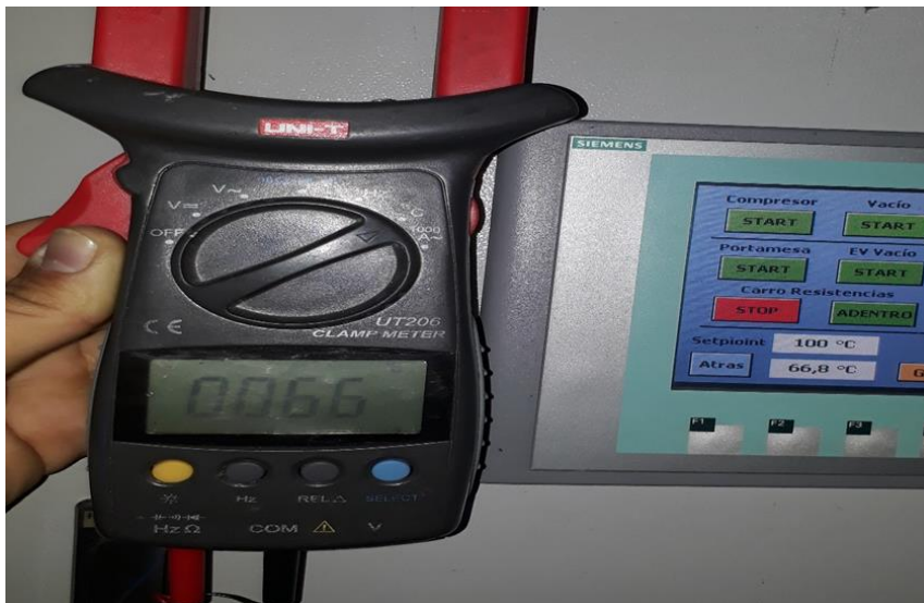
Figura 28. Comparación del set point de la máquina con medición tomada de pinza (fuente autores)
