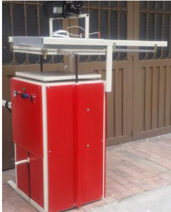
Figura 3. Termoformadora de sistema de control por pulsado de encendido y apagado manualmente sin un control preciso de temperatura. (Termoformadoras Osorno, 2017)
