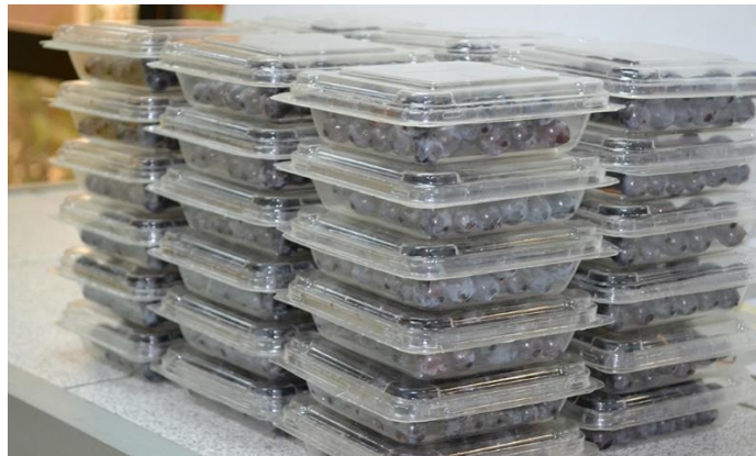
Figura 10. Recipientes para fruta fabricados por termoformado. (Tecnología del plástico, 2017)
