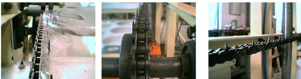
Figura 7. Sistema de arrastre para polímero en cadena. (España, 2005)
