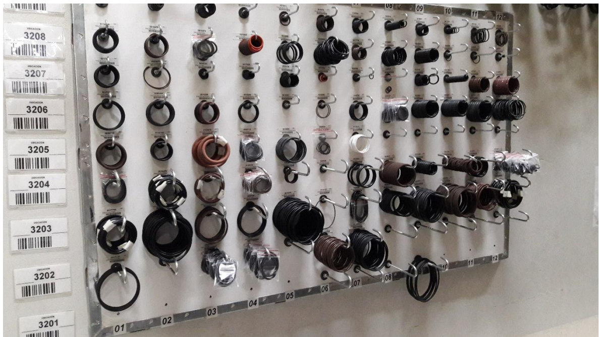
Ilustración 5: Grupo Orings del almacén de repuestos.
