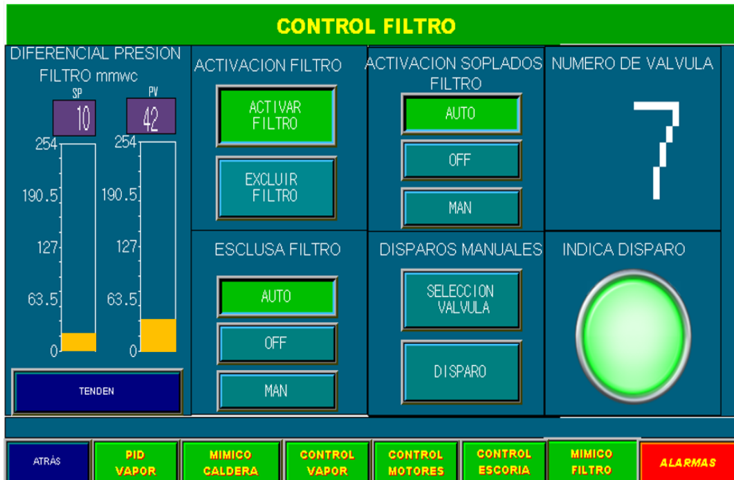
Figura 47. Pantalla de control del filtro. Fuente: Propia, toma del programa GT Designer.
