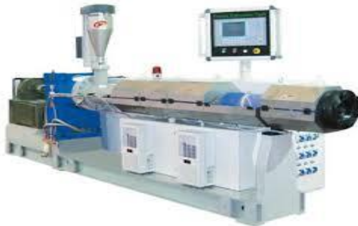
Ilustración 14. Extrusora de un solo husillo ( Friend New Tech, 2018 )
