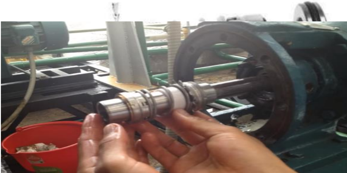
Ilustración 10. Sello mecánico para bombas recirculadoras de amoníaco Cornell Pumps (Seals, 2010)
