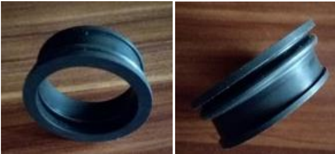
Ilustración 13. Muestra sello mecánico original de las bombas para trabajo con amoniaco.
