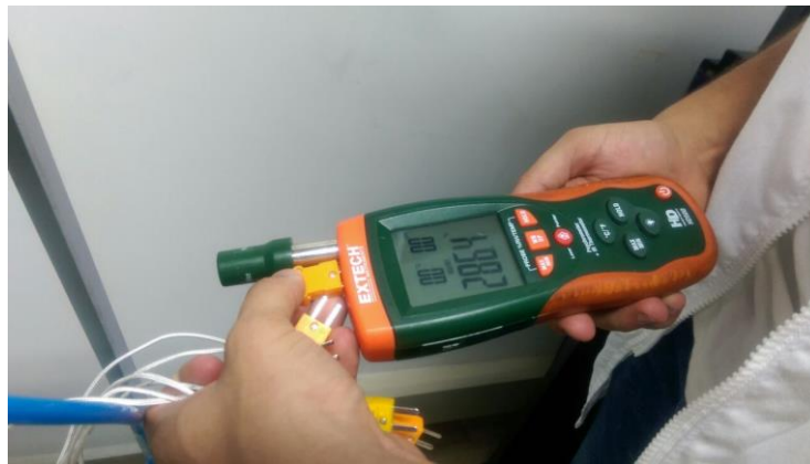
Ilustración 42. Medición de temperatura en los diferentes puntos de la placa.
