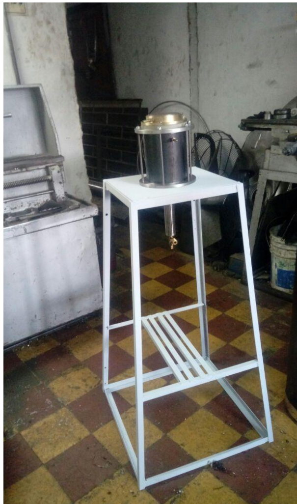
Ilustración 20. Estructura final del quemador para realizar la configuración experimental.
