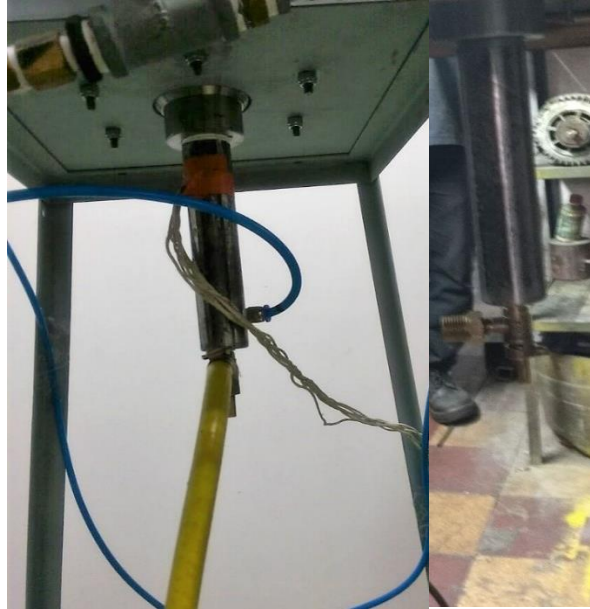
Ilustración 18. Tubo de suministro con el inyector acoplado por medio de rosca y montaje final con las mangueras de suministro.
