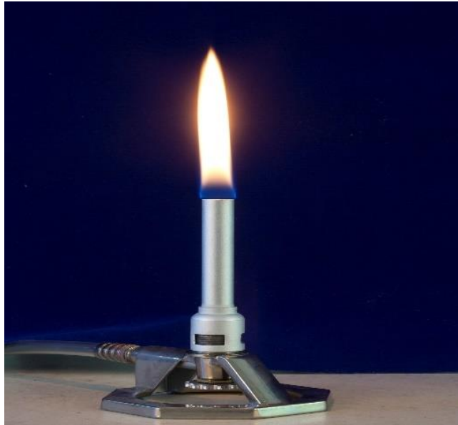
Ilustración 4. Quemador bunsen de llama amarilla.
