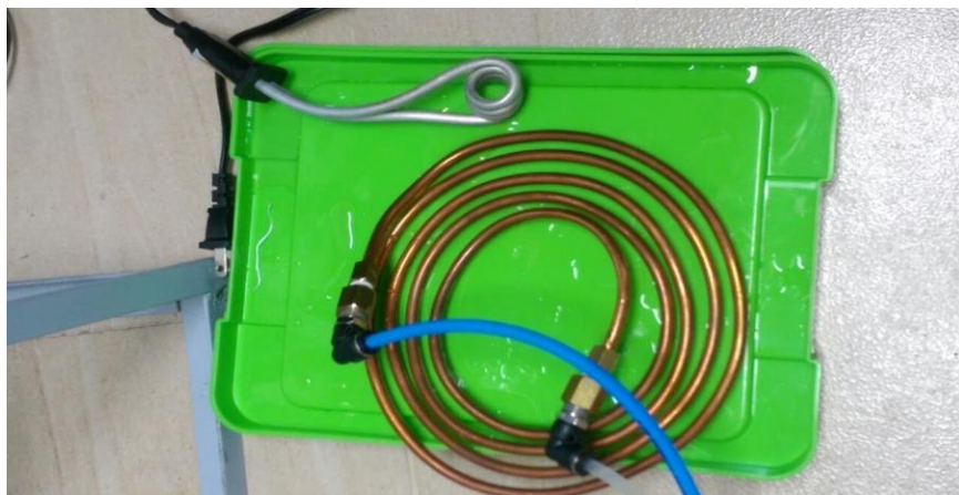
Ilustración 27. Intercambiador de calor
