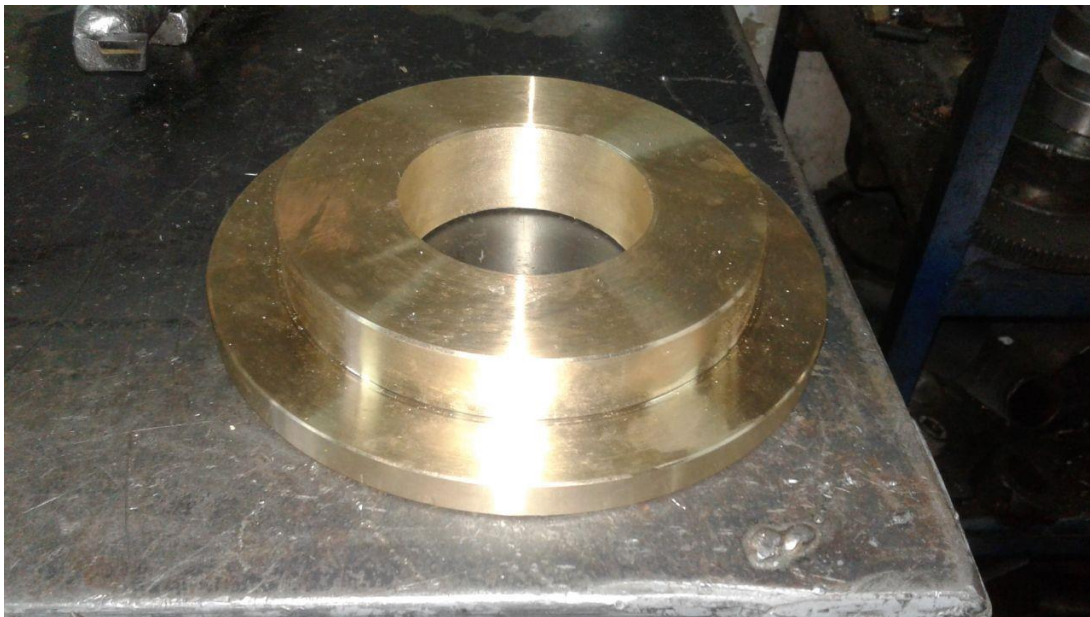
Ilustración 35. Fabricación de la Tapa superior en cobre.
