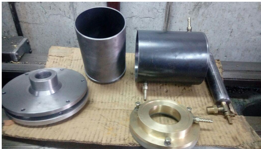
Ilustración 19. Despiece del quemador de llama plana laminar fabricado.
