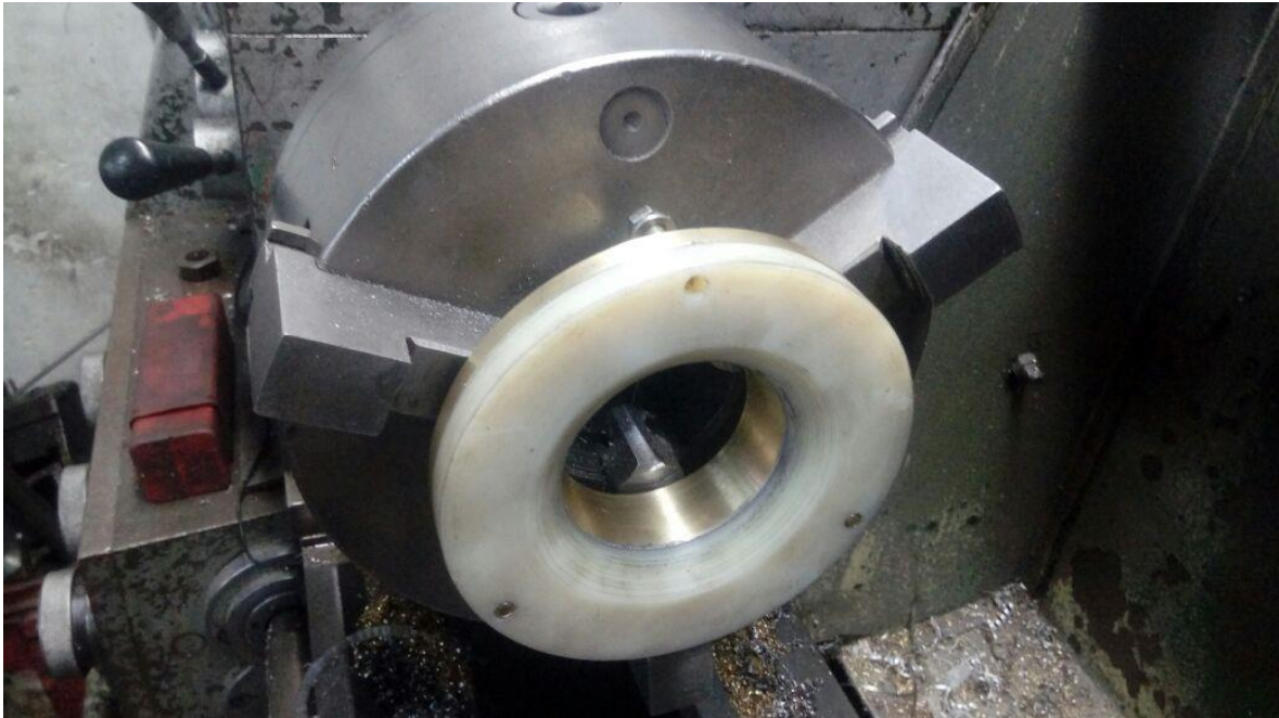
Ilustración 36. Fabricación de la tapa superior con su respectivo radio de curvatura
