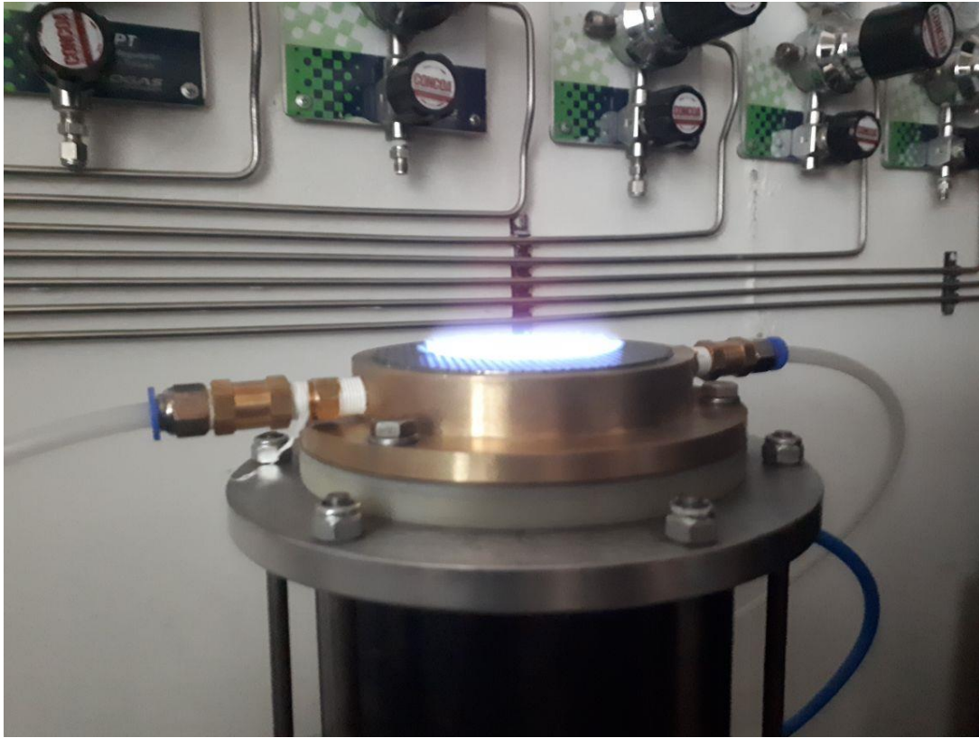
Ilustración 39. Llama plana estabilizada
