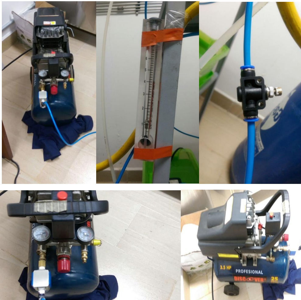
Ilustración 25. Imágenes del compresor, rotámetro y válvula reguladora de aire utilizados en la prueba.
