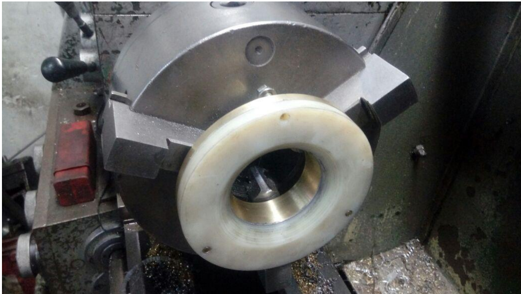
Ilustración 13. Unión de la pieza de cobre y el disco de nylon para realizar el radio de curvatura
