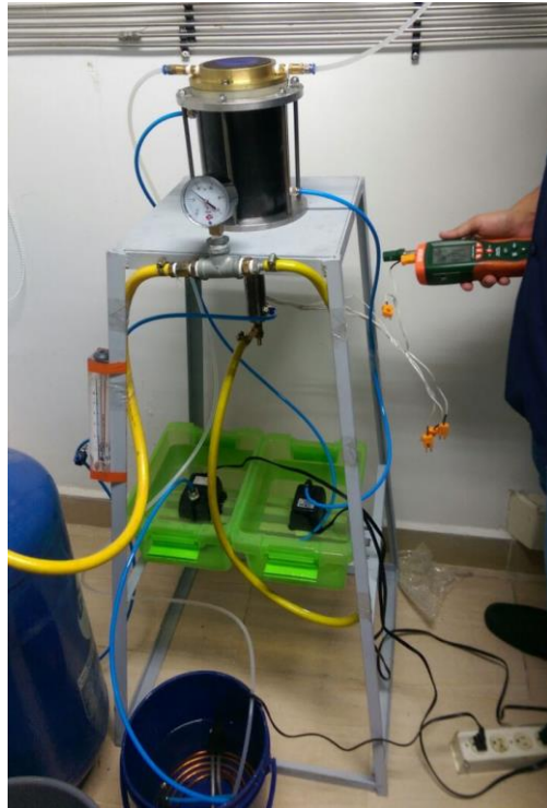
Ilustración 30. Montaje del quemador de llama plana
