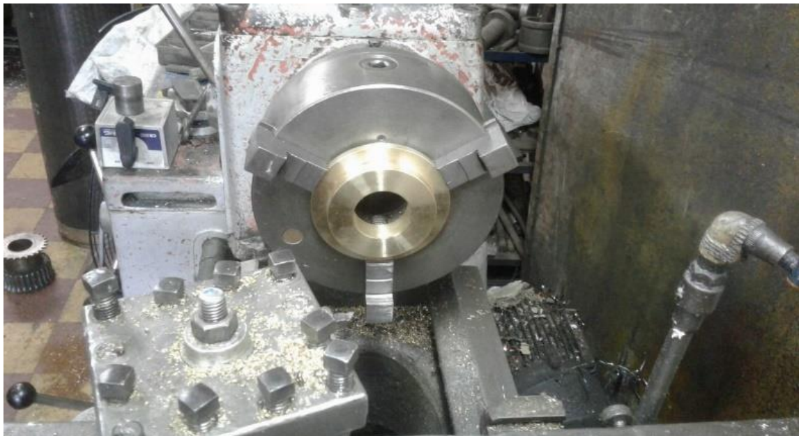
Ilustración 12. Mecanizado del cobre para el modelo de la tapa superior del quemador.
