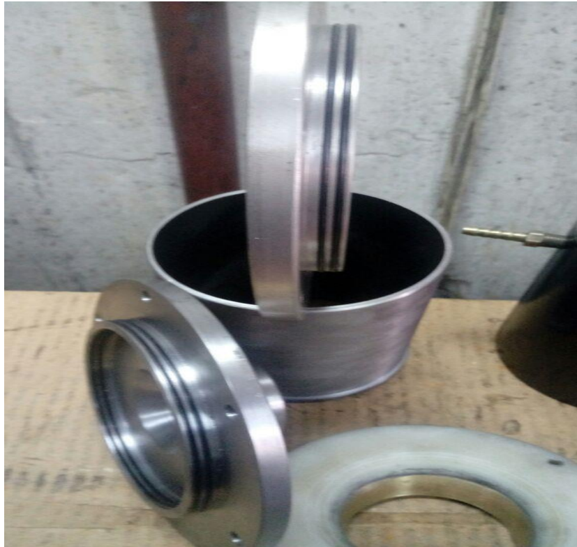
Ilustración 37. Sellos empleados como solución de fugas.
