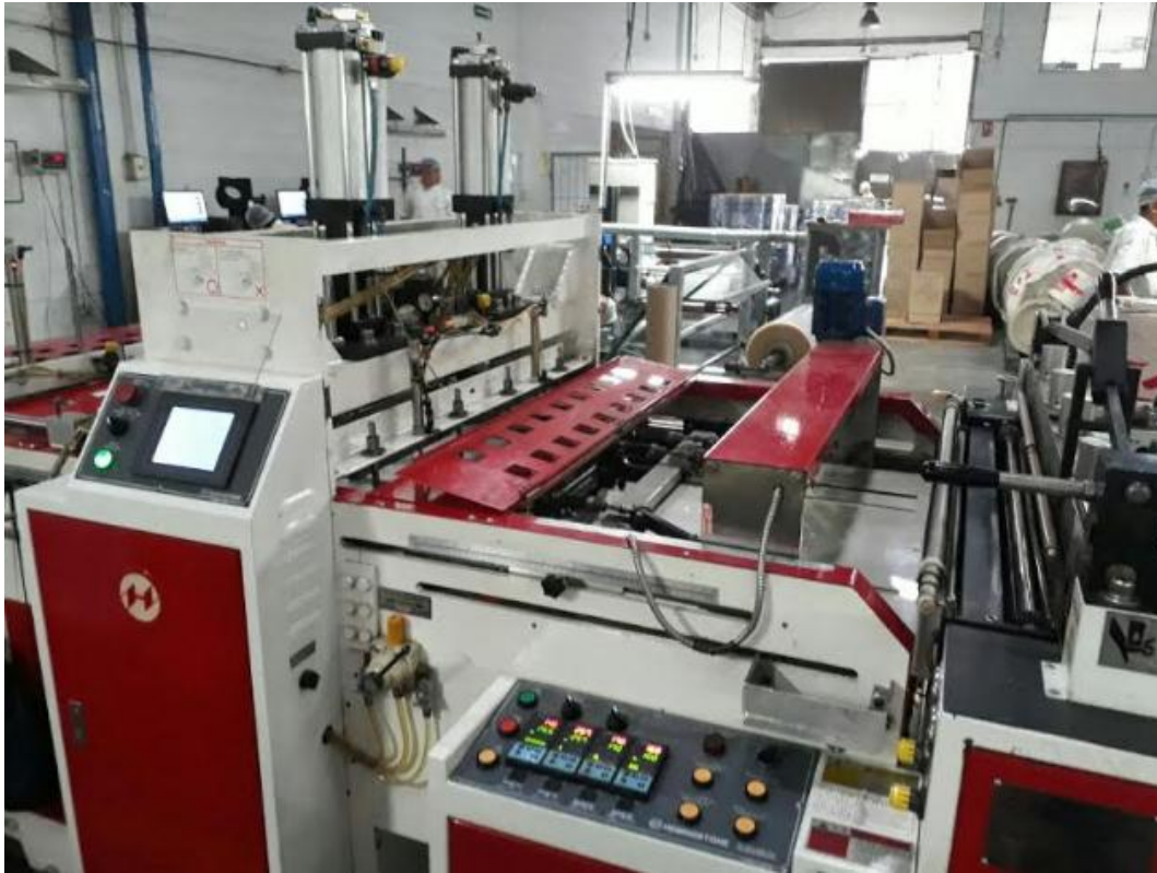
Imagen 22. Selladora de bolsas. Fuente: Empresa Plasmar s.a
