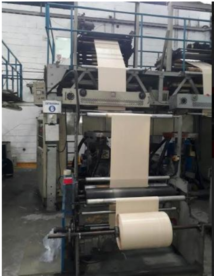
Imagen 20. Extrusora. Fuente: Empresa Plasmar s.a
