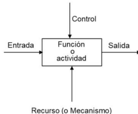
Figura 5. Esquema de una función o actividad en el método IDEF0. Tomado de (Díaz Chasoy & Pinto Camacho, 2020)
