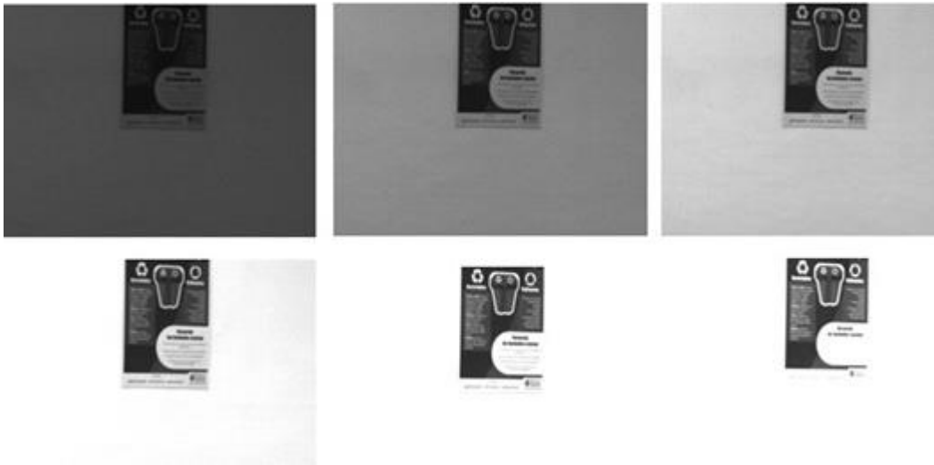
Fig.44. Adquisición de imágenes con ganancia máxima y el tiempo de exposición 80 a 972.
