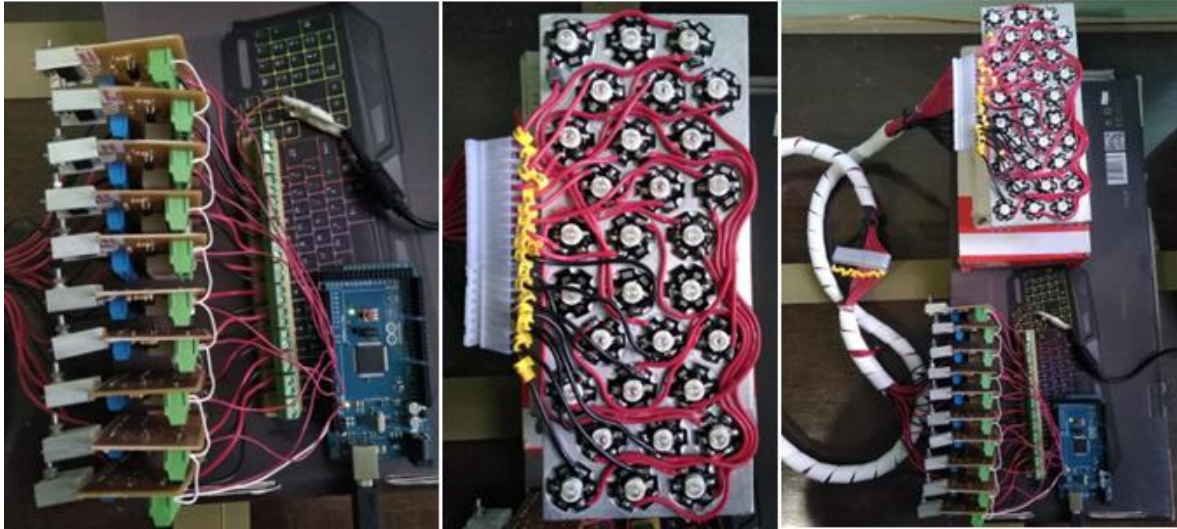
Fig.40. Montaje físico de la lámpara hiperespectral.
