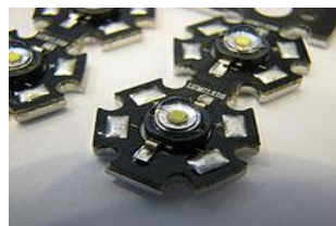
Fig.10. Diodos emisores de luz de alta potencia conectados a una base en estrella para LedLuxeon y Lumuleds. (Wikipedia.led.2018).
