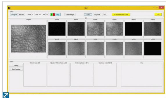
Fig.5. Interfaz desarrollada en MATLAB como GUI para el sistema (Setiadi&Nasution, 2018.IEEE).
