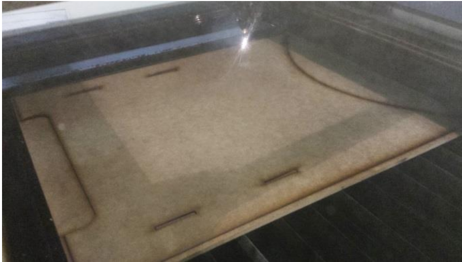
Imagen 6. Corte laser de costilla. Fuente propia.
