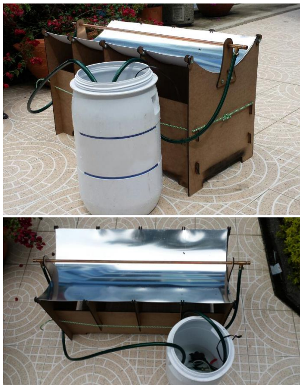
Imagen 15. Colector completo en funcionamiento. Fuente propia.
