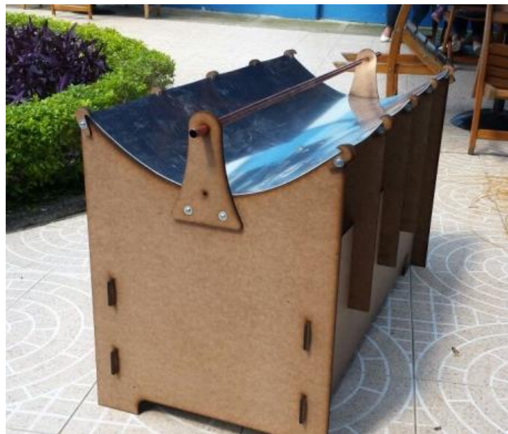
Imagen 10. Tubería y láminas acopladas. Fuente propia.
