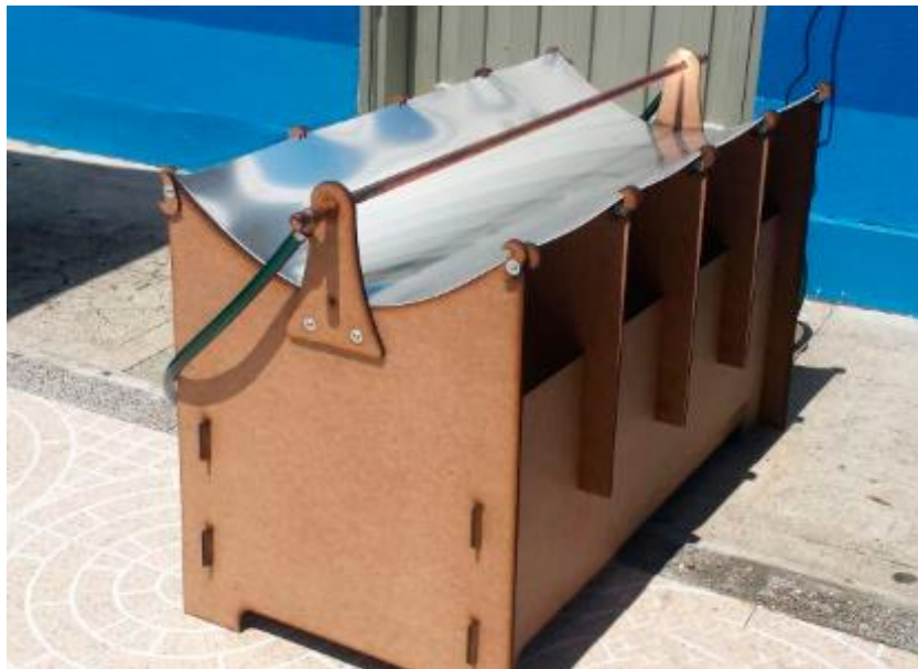
Imagen 11. Colector en funcionamiento. Fuente propia.
