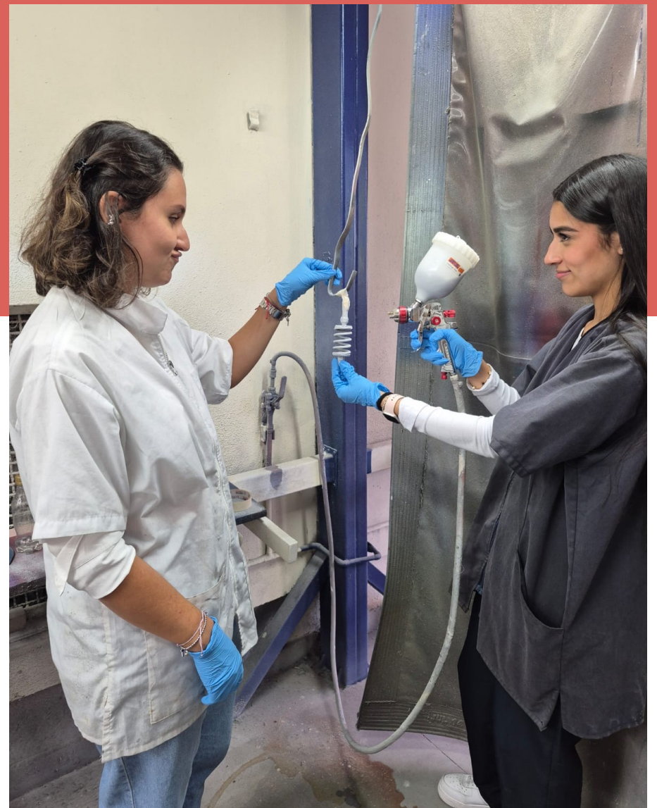
Proceso de recubrimiento del resorte. El acabado de los materiales influye en la conservación de las propiedades mecánicas, ópticas y de resistencia al ataque químico.
