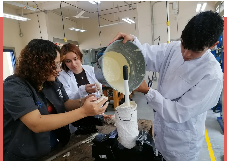
Fabricación del molde positivo para la cuenca protésica mediante vaciado en yeso.
